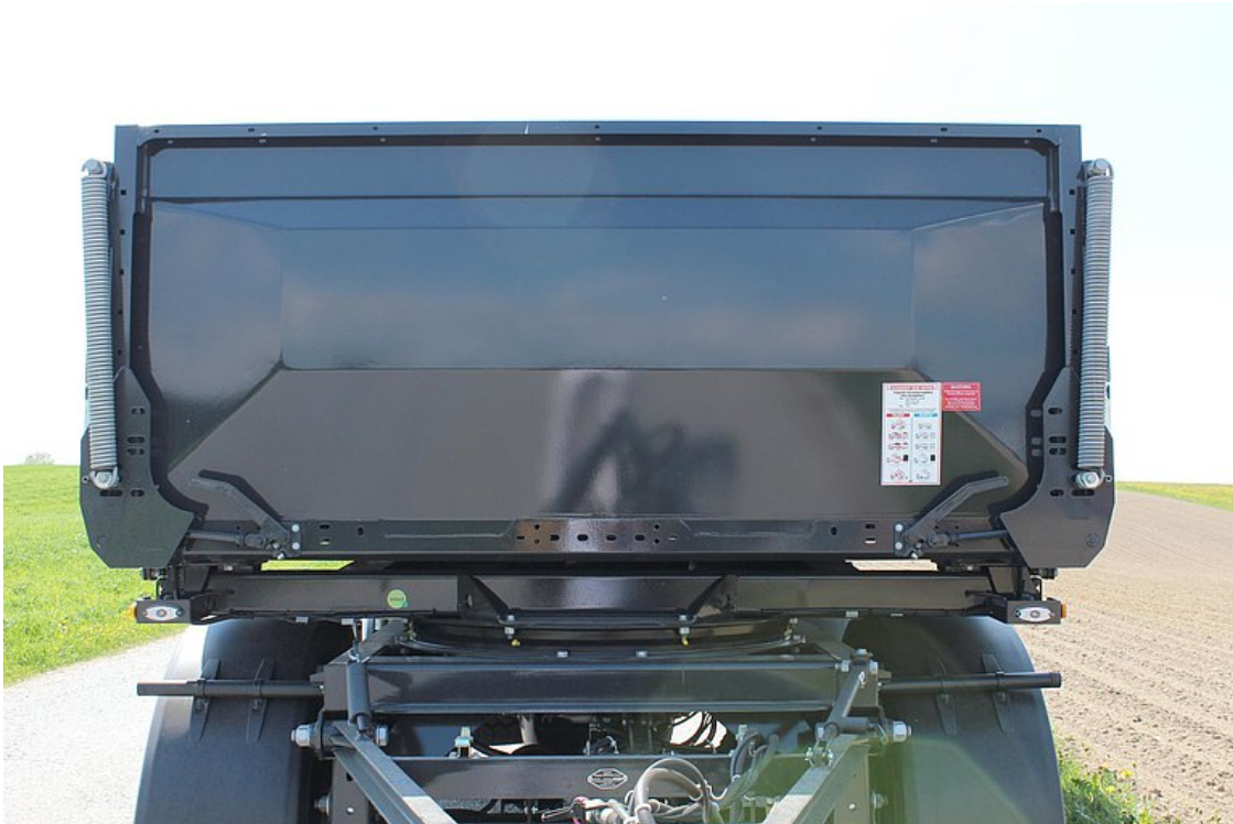
Stała ściana przednia z blachy stalowej
