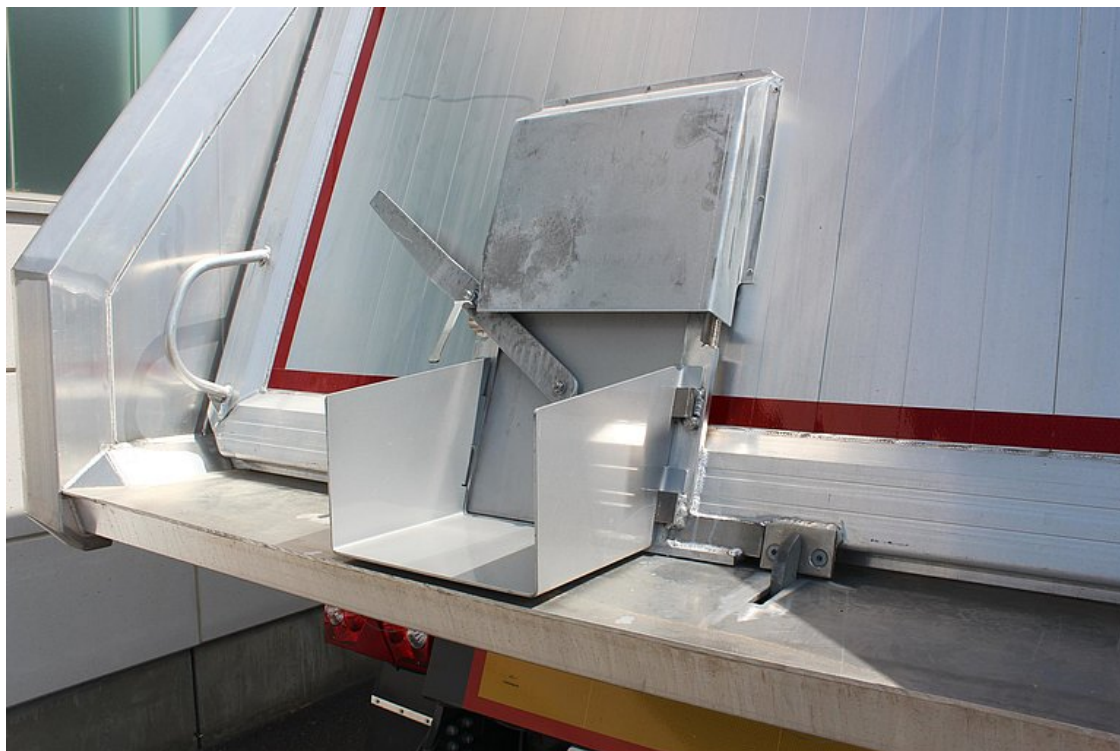
OPCJONALNIE: szuflada na zboże z dźwignią dozującą i lejem wylotowym zdejmowana na tylnej ścianie wahlowej
