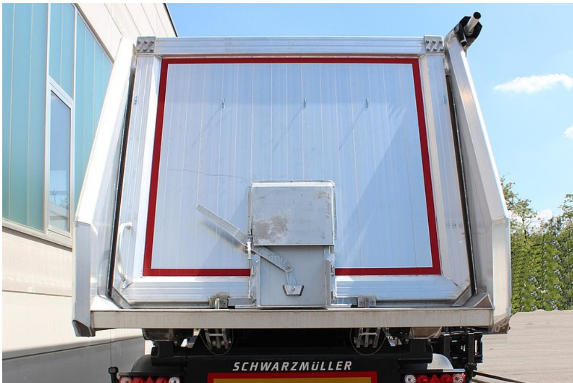
Tylna ściana = ściana wahliwa z wpuszczonymi łożyskami i automatycznym mechanicznym centralnym zamknięciem 2-hakowym
