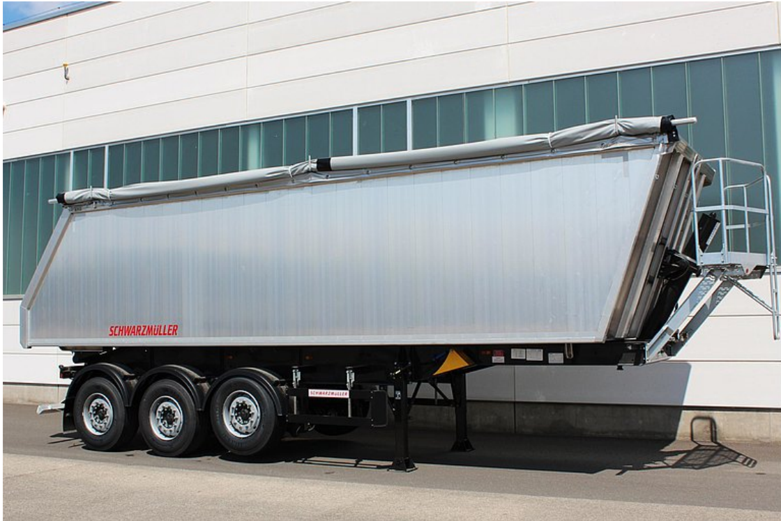
3-osiowa naczepa siodłowa wywrotka aluminiowa ze skrzynią
