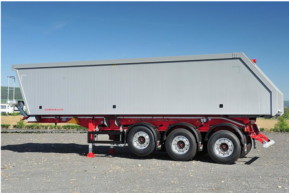
3-osiowa naczepa siodłowa wywrotka w całości aluminiowa ze skrzynią z profili zamkniętych
