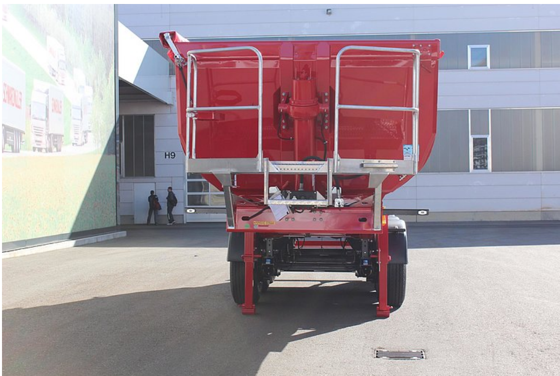
Izolowana ściana przednia z chromowanym na twardo, wysokiej jakości przednim siłownikiem przechyty
