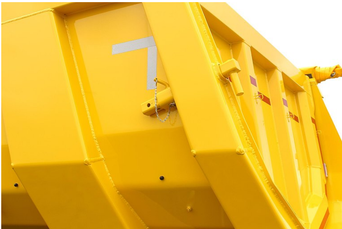
OPCJONALNIE: urządzenie dozujące do tylnej ściany wahlowej z wyciąganym ogranicznikiem rurowym
