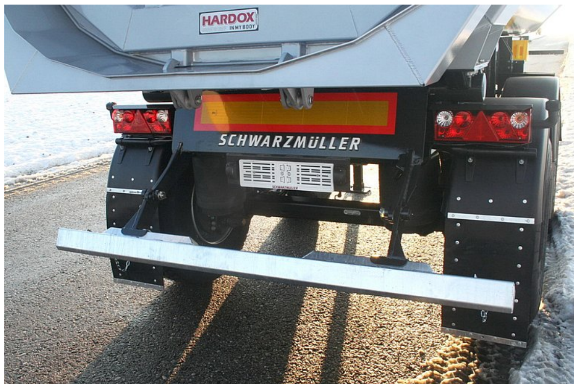
Aluminiowa osłona przeciwnajazdowa, trapezowa, składana
