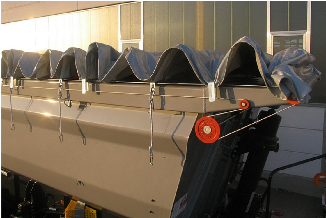
OPCJONALNIE: dach rolkowy - może być obsługiwany ręcznie lub elektrycznym pilotem zdalnego sterowania
