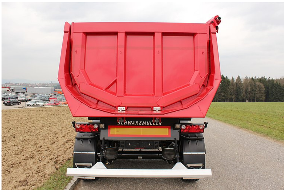
Tyłna ściana = ściana wahlowa z wpuszczonymi łożyskami i automatycznym mechanicznym centralnym zamknięciem 2-hakowym
