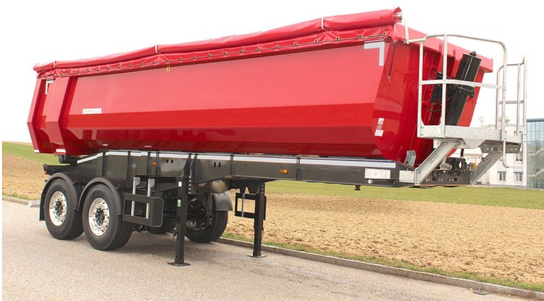
2-osiowa naczepa siodłowa wywrotka aluminiowa ze skrzynią
