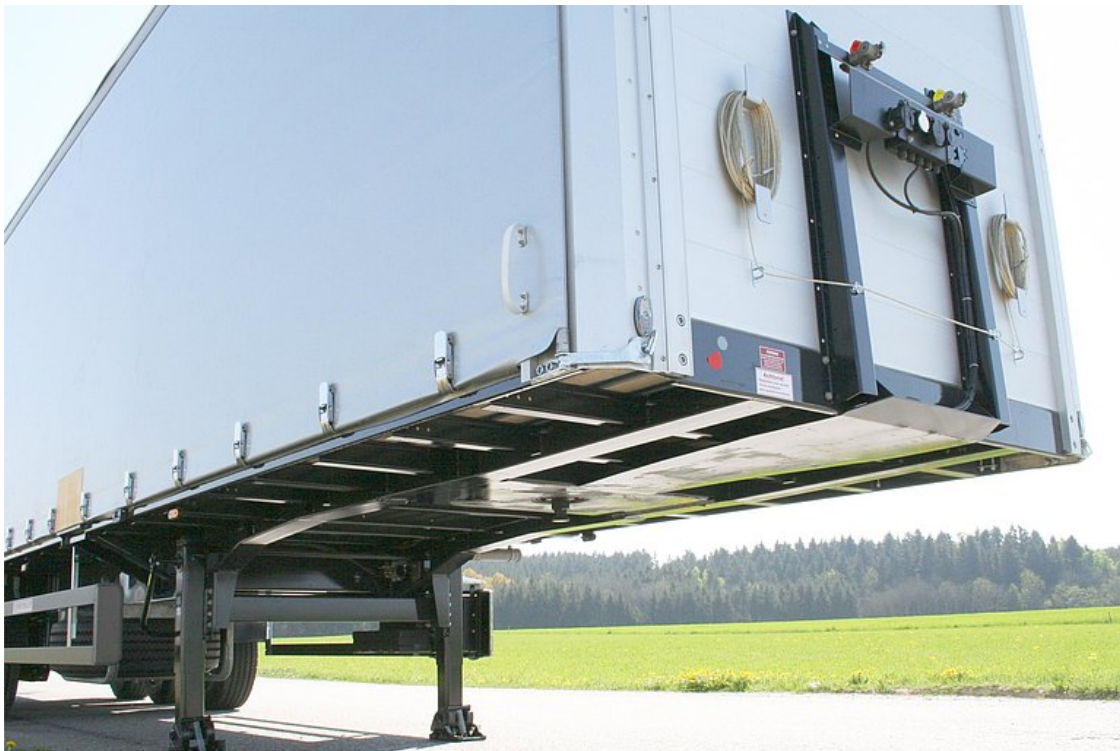
Odporna na skręcanie spawana konstrukcja ramy drabinowej
