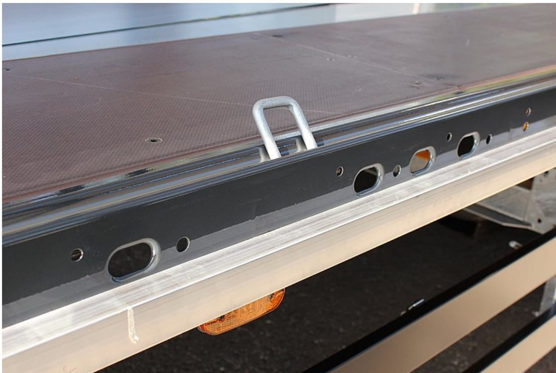
Rama zewnętrzna z otworami o rozstawie ok. 100 mm, otwór podłużny 40/25 mm zgodnie z DIN EN 12640 i 23 pary wpuszczanych uchwytów mocujących 2,5 t
