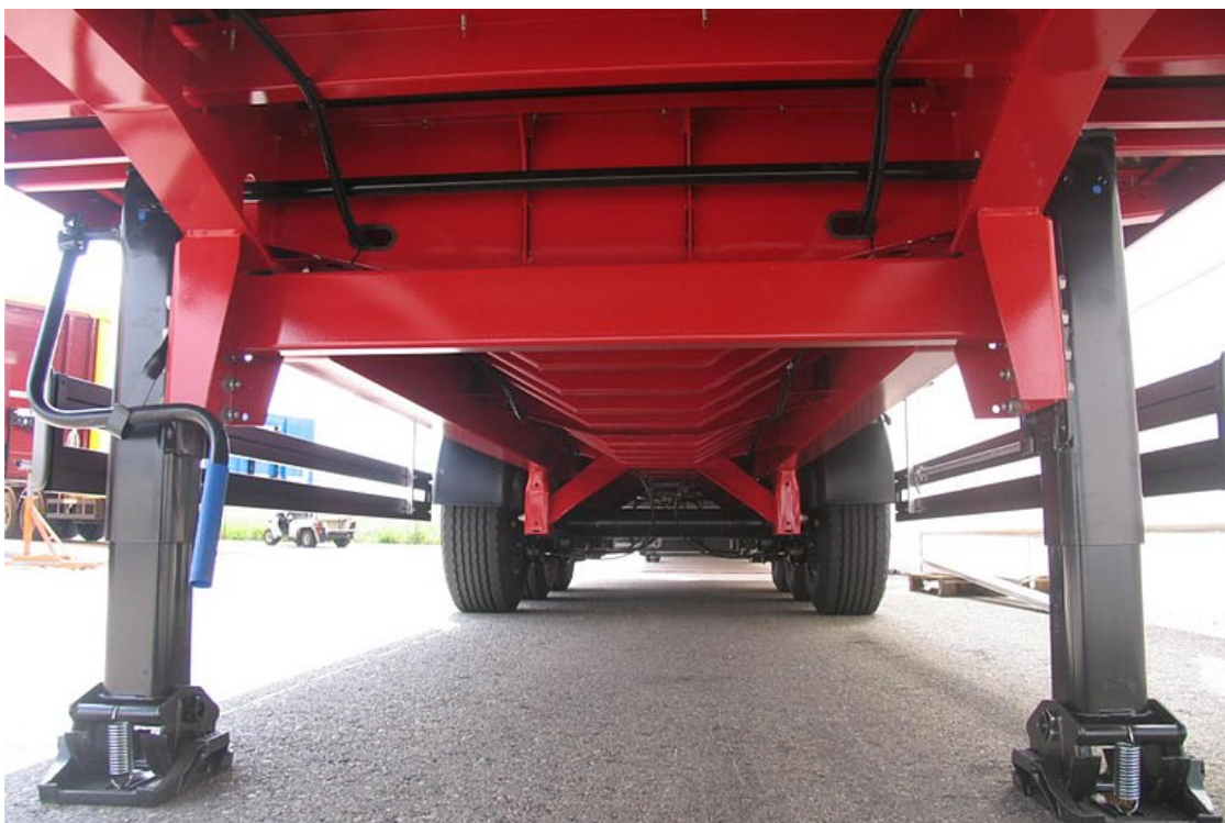
Wzmocniona konstrukcja ramy do transportu zwojów 30 t w środku ciężkości na minimum 1 500 mm długości załadunku
