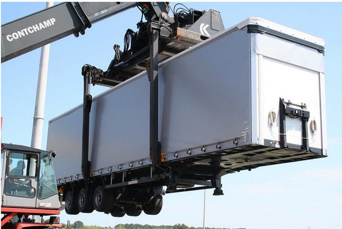
Przykład załadunku na terminalu kolejowym
