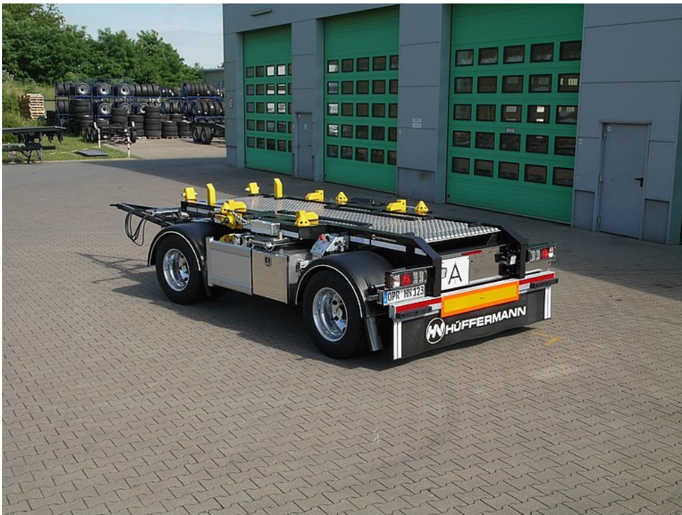
Wyposażenie specjalne do jednego kontenera bramowego z elegance edition, Safety-Fix i podłogą do pras do odpadów
