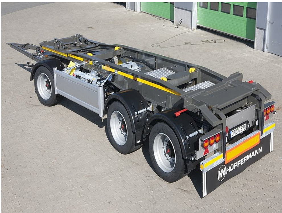
Wyposażenie specjalne z 3 okrągłymi lampami LED i otwartą boczną osłoną przeciwnajzdową
