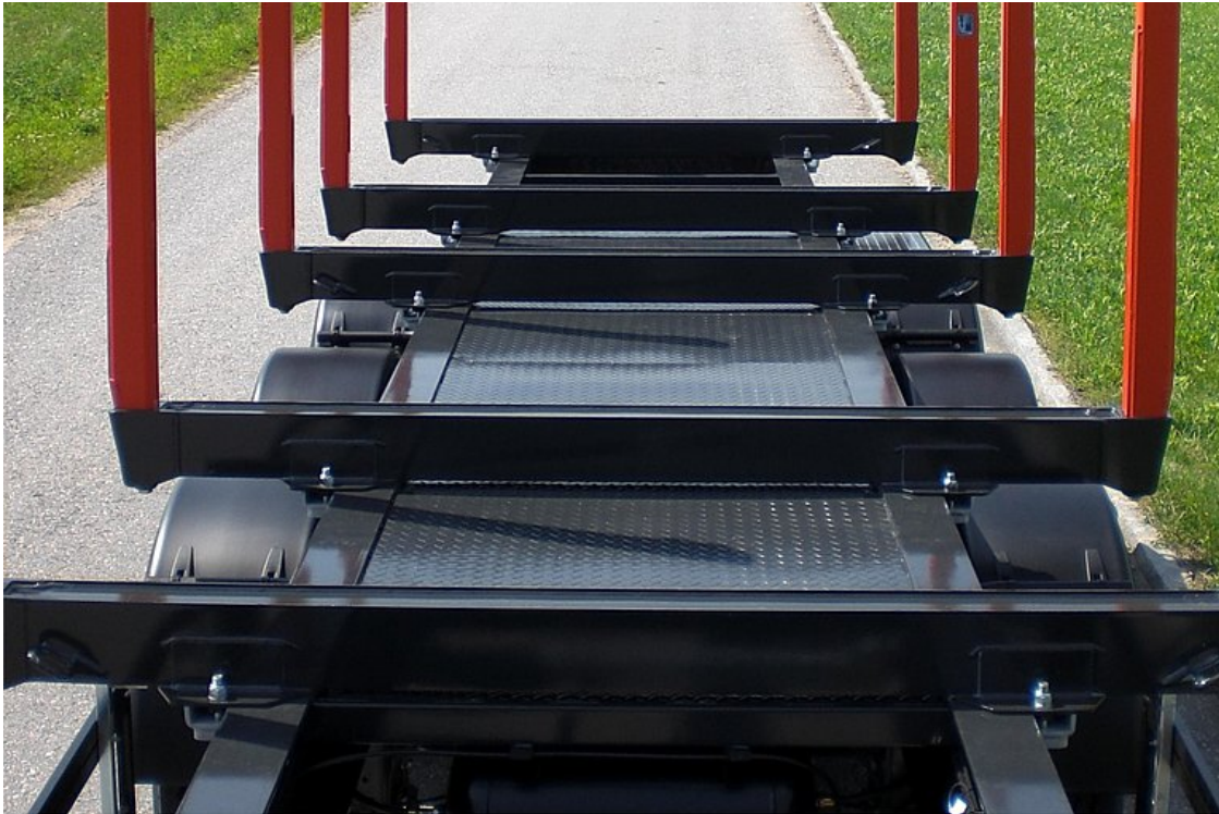
Osłona ze stalowej blachy z owalnymi żeberkami między podłużnicami ramy nad podwoziem i z przodu
