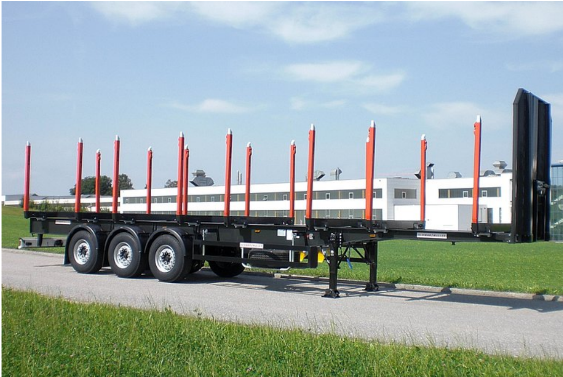
3-osiowa naczepa siodłowa kłonicowa bez platformy
