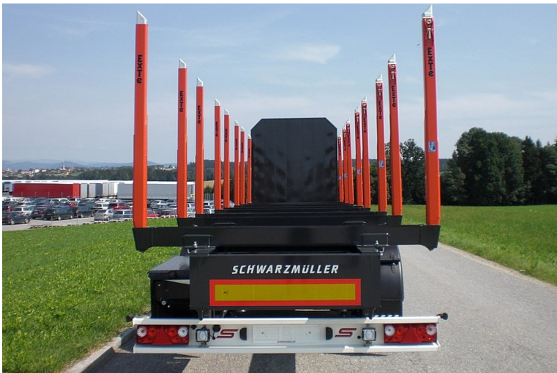
Tyłny koniec z zamontowaną aluminiową osłoną przeciwnajzdową
