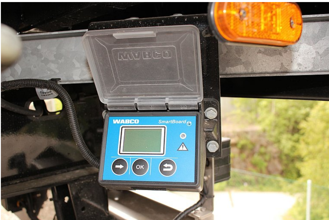
OPCJONALNIE: SmartBoard do odczytywania danych z wyświetlacza w pojeździe (przebieg, obciążenie zespołu osi, diagnostyka hamulców itp.)
