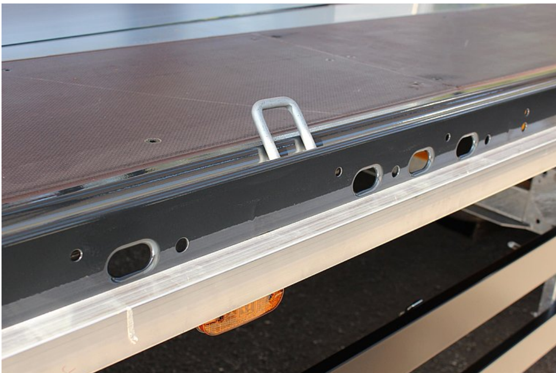
Furatos keretszegély ca. 100 mm lyuktávolsággal, 40/25 mm-es oválfuratokkal a DIN EN 12640 szabvány szerint és 23 pár süllyesztett 2,5 t lekötőgyűrűvel
