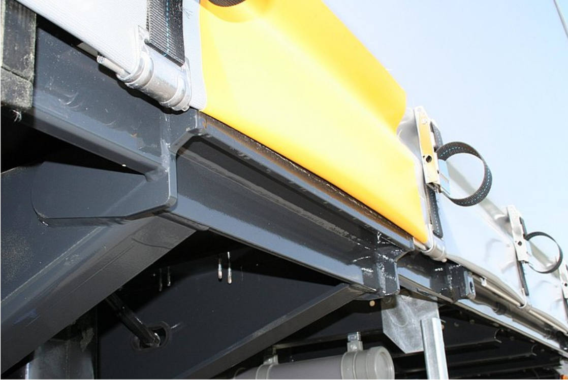
Erősített alvázfelépítés 4 fogadózseb, daruzható vasúti rakodáshoz
