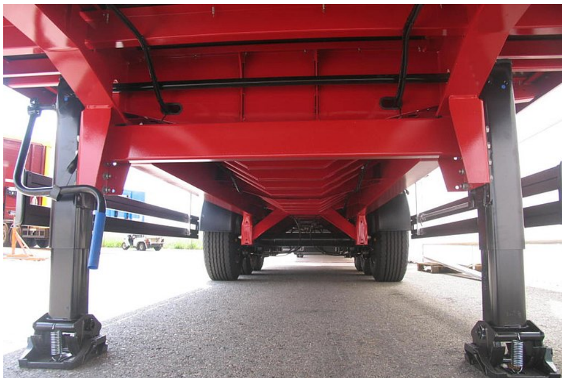
Erősített alvázkonstrukció, a súlypontban elhelyezett, legalább 2.000 mm hosszban szállított 27t tömegű kábeldobhoz
