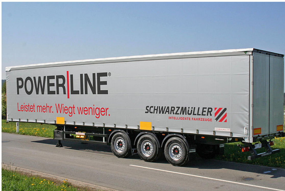
3-tengelyes, függönyponyvás, síkplátós félpótkocsi - tekercsszállító - HuckePack
