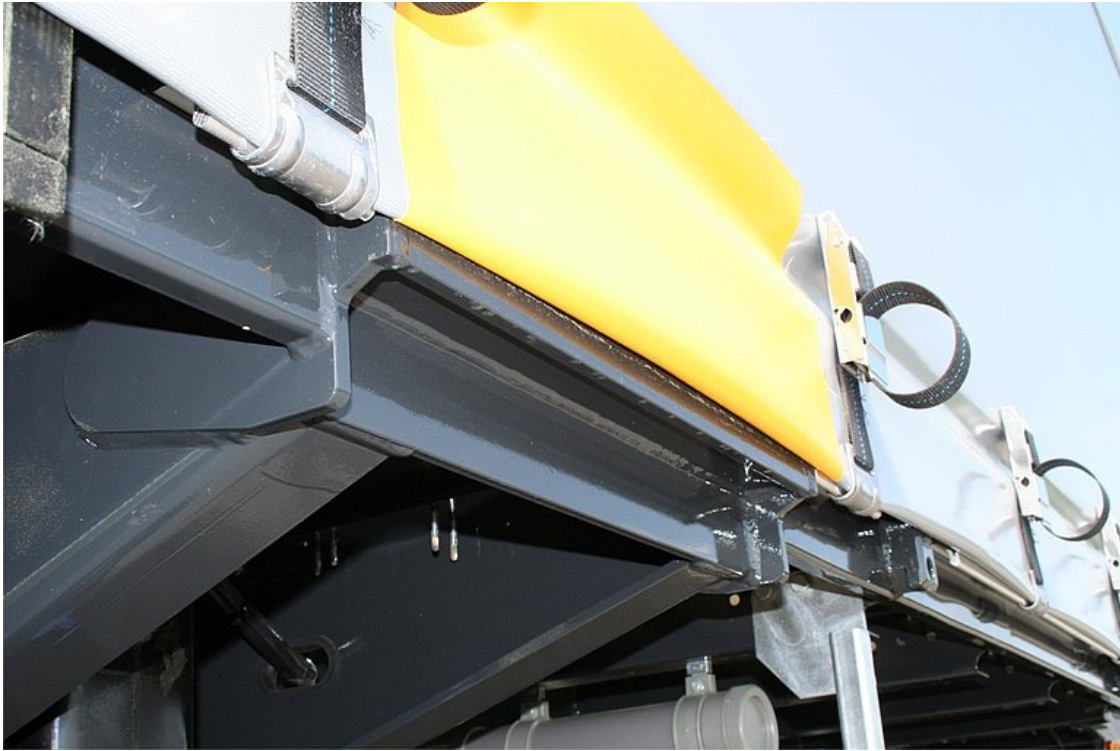
Erősített alvázfelépítés 4 fogadózseb, daruzható vasúti rakodáshoz
