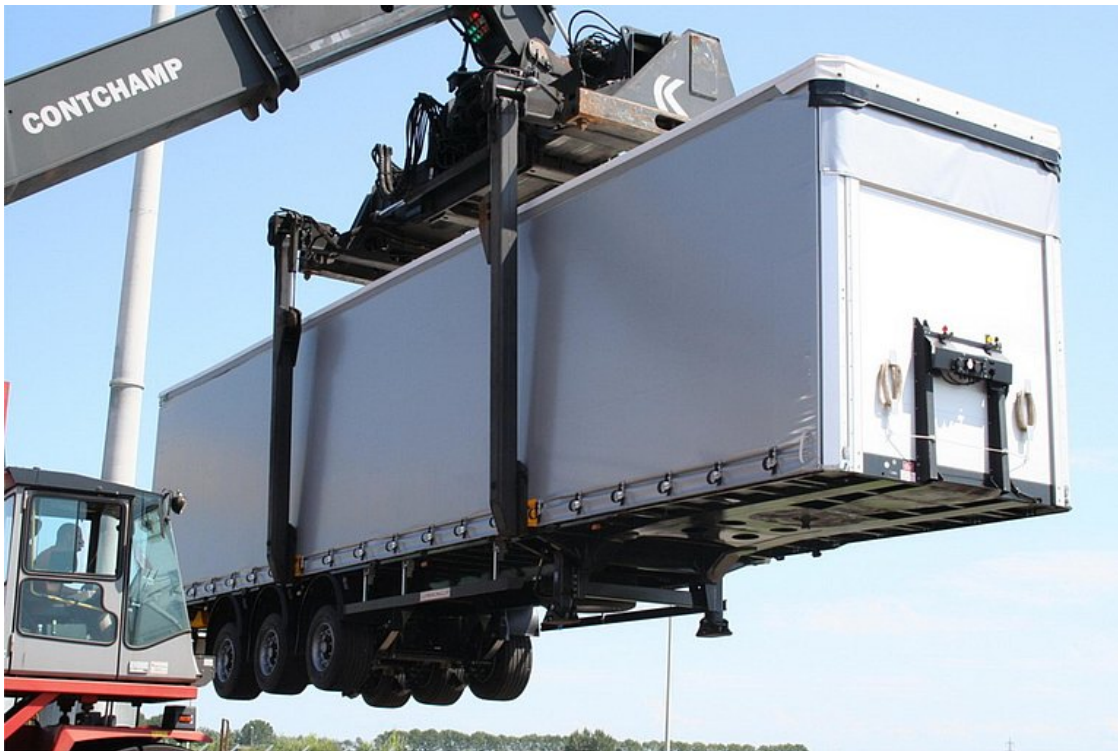
Rakodási példa vasúti szállításnál
