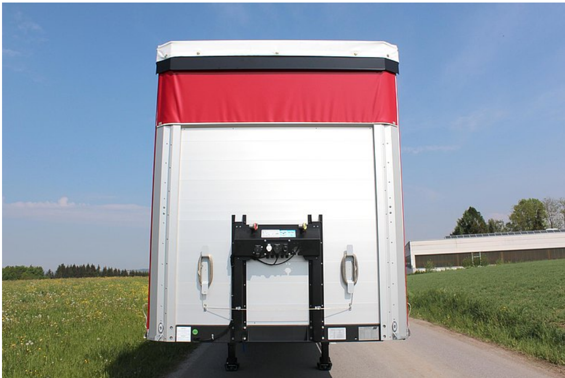
Erősített, üreges alumínium profil mellfal, aljzattartóval
