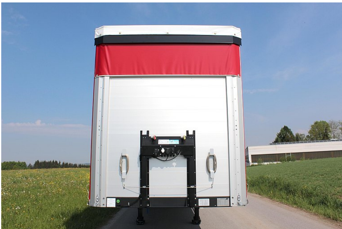
Erősített, üreges alumínium profil mellfal, aljzattartóval
