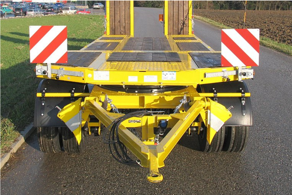
Forgósámoly és vonóháromszög, kihúzható figyelmeztető táblával
