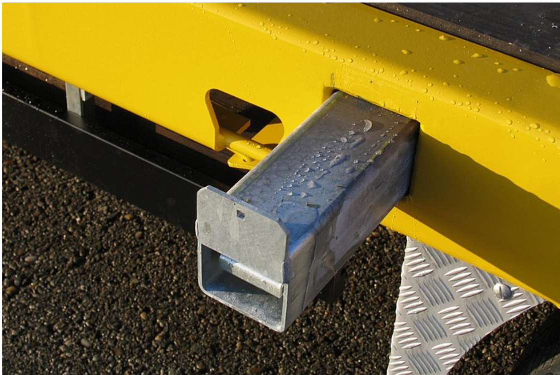
Kihúzható szélesítések pallókkal, túlméretes áruk szállítására
