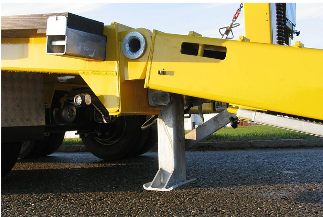
Hátul a rámpáknál, illetve az alvázvégen, oldalanként 1 automatikus támasztóláb
