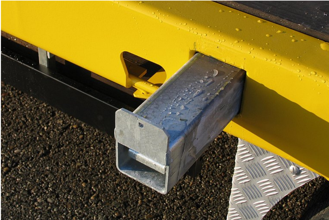
Kihúzható szélesítések pallókkal, túlméretes áruk szállítására
