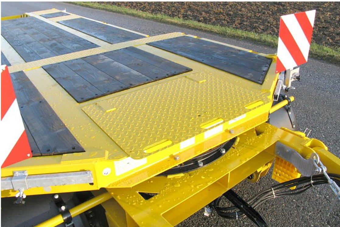
Fedéllel ellátott tárolórekesz a magasított rakfelületen
