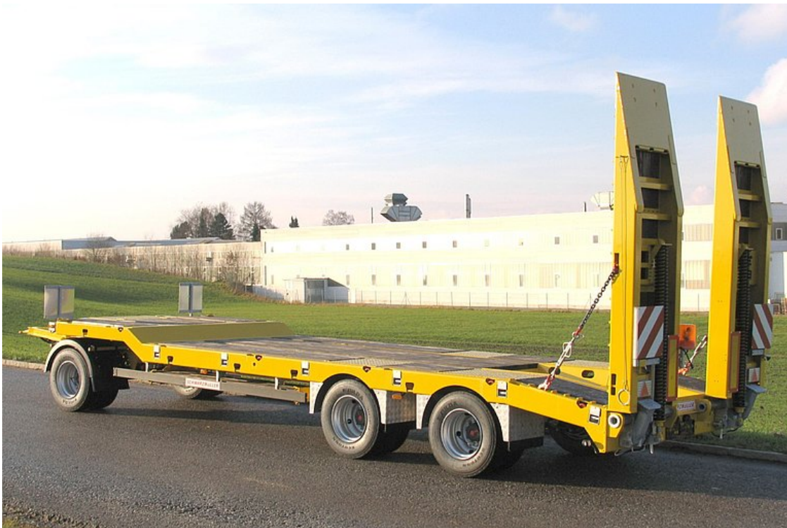
3-tengelyes, hajlított rakfelületű, nehézgépszállító pótkocsi
