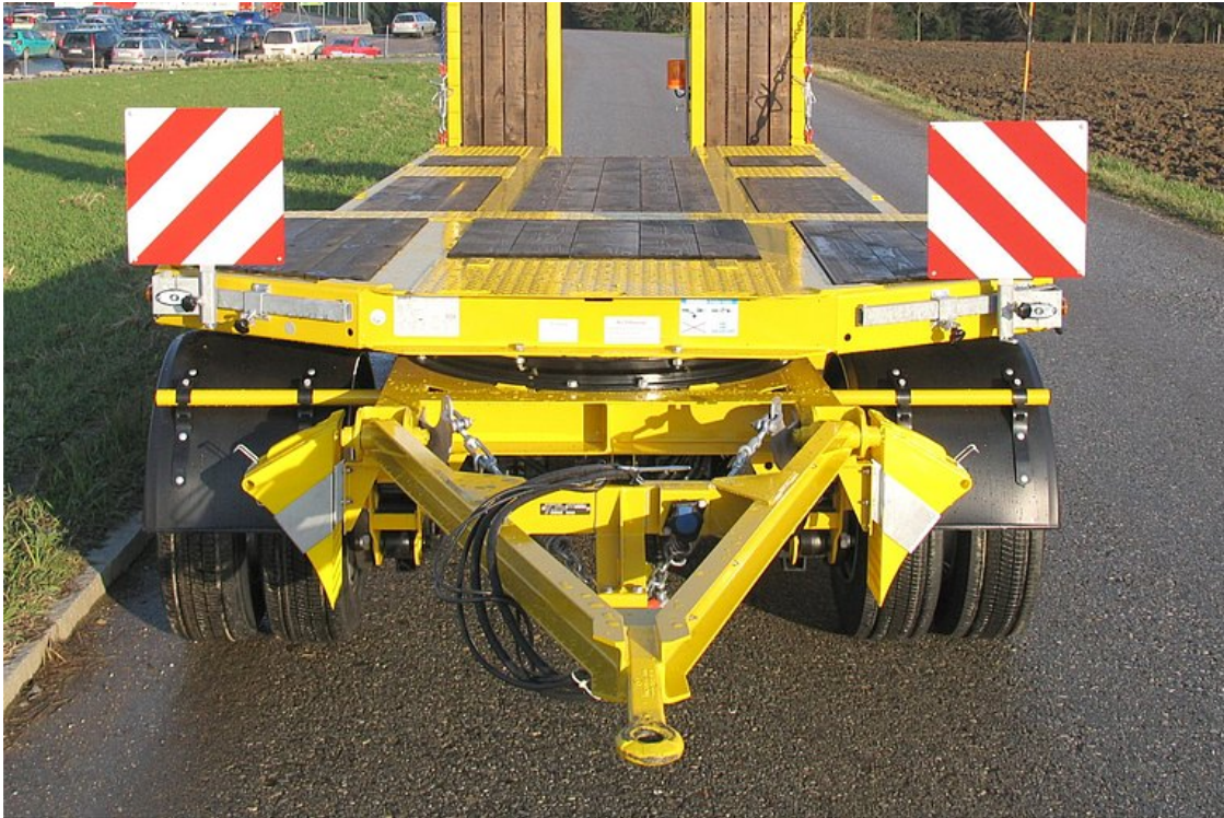
Forgósámoly és vonóháromszög, kihúzható figyelmeztető táblával
