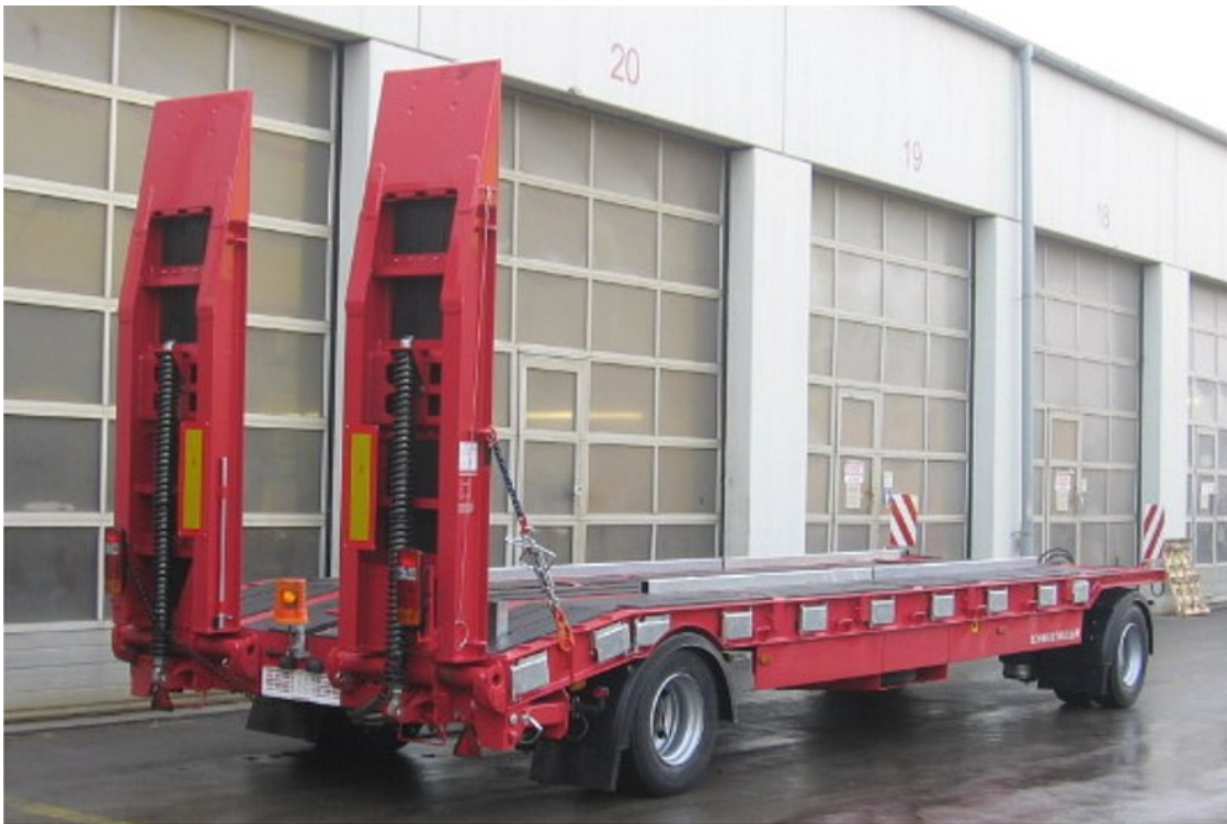
2-tengelyes, egyenes rakfelületű, nehézgépszállító pótkocsi
