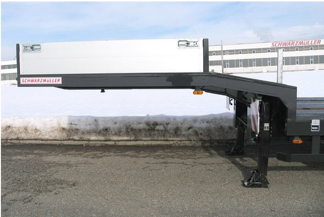
Elöl alvázhajlítással megemelt rakfelület, betűzhető oldalfalakkal
