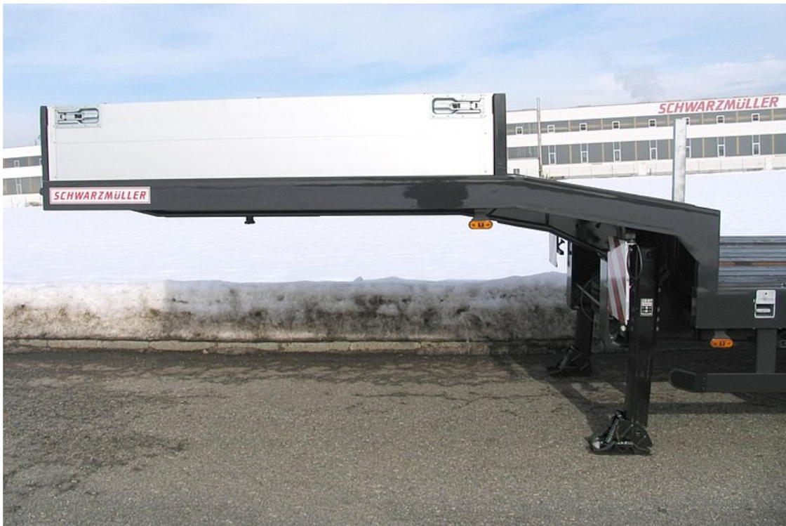
Elöl alvázhajlítással megemelt rakfelület, betűzhető oldalfalakkal
