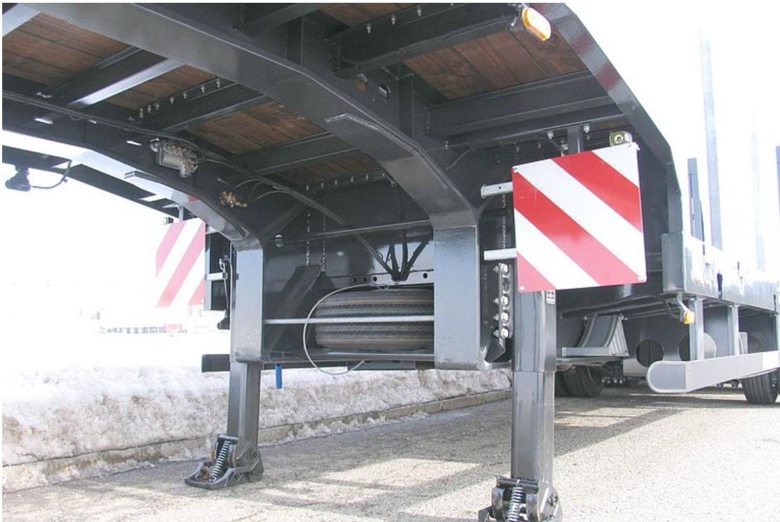
Erősített és csavarodásálló, hegesztett acélkonstrukció és sűrűn elhelyezett kereszttartók, a magas pontszerű terhelhetőségért
