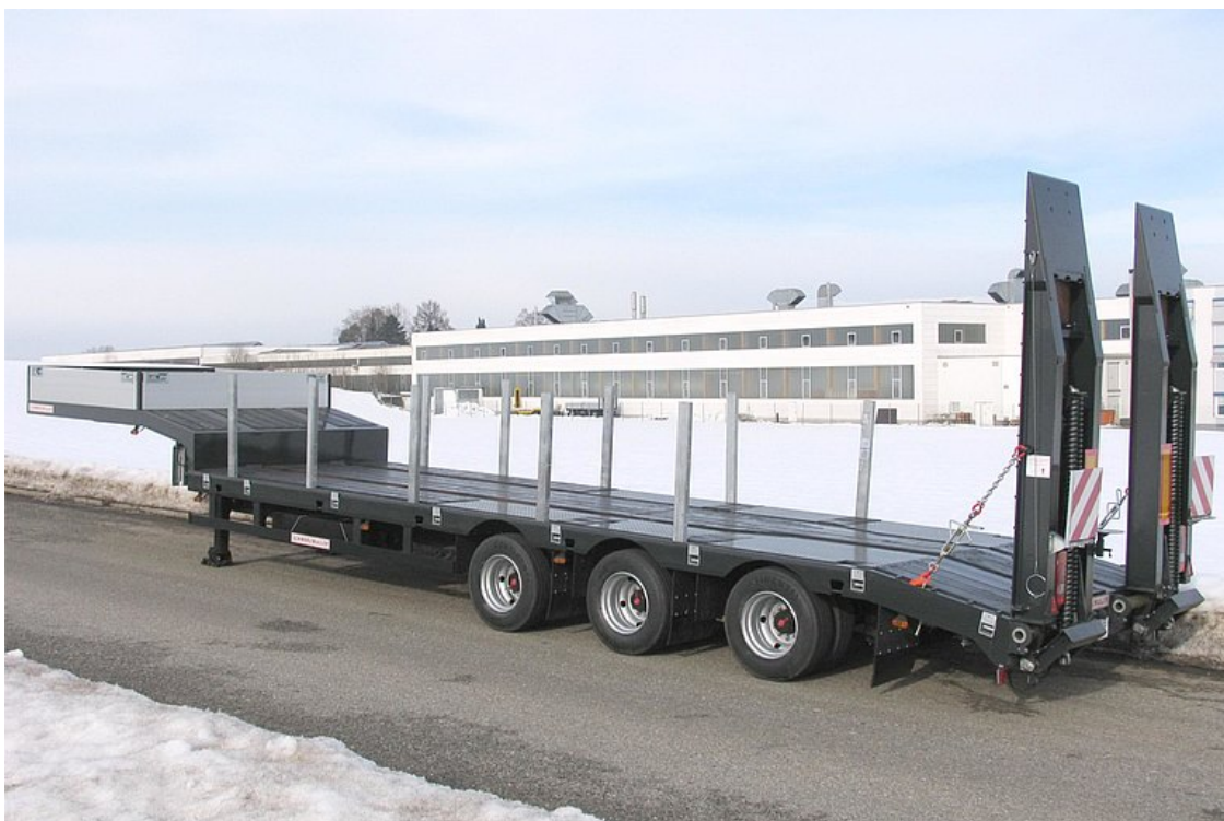
3-tengelyes, nehézszállító félpótkocsi - erősített
