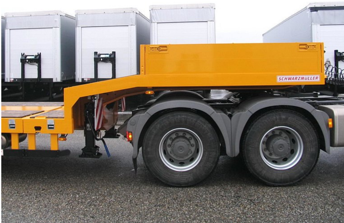
Elöl alvázhajlítással megemelt rakfelület, betűzhető oldalfalakkal
