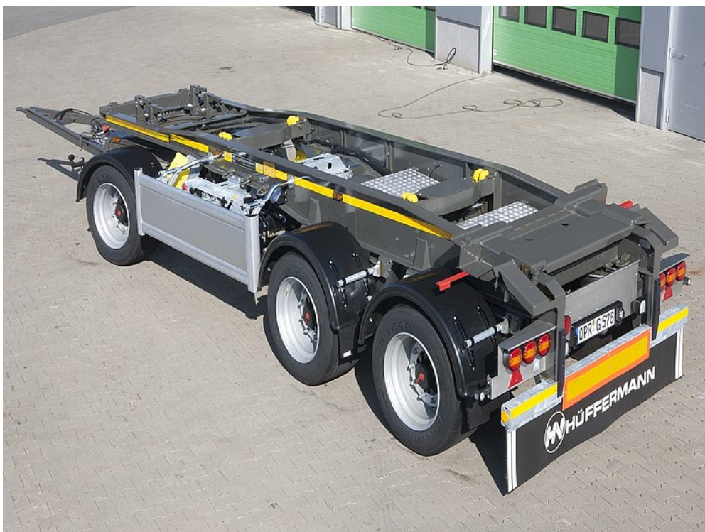
Különleges kivitel 3 db LED-es kerek lámpával, zárt oldalsó aláfutásgátlóval
