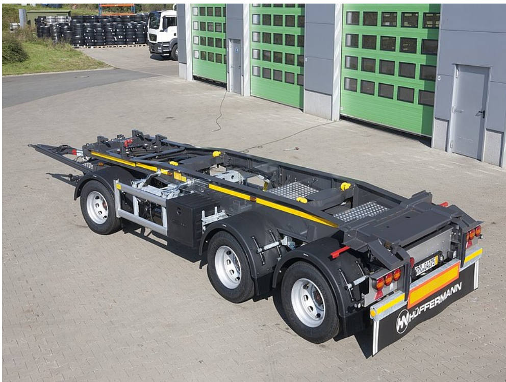
Különleges kivitel 3 db LED-es kerek lámpával, nyitott oldalsó aláfutásgátlóval
