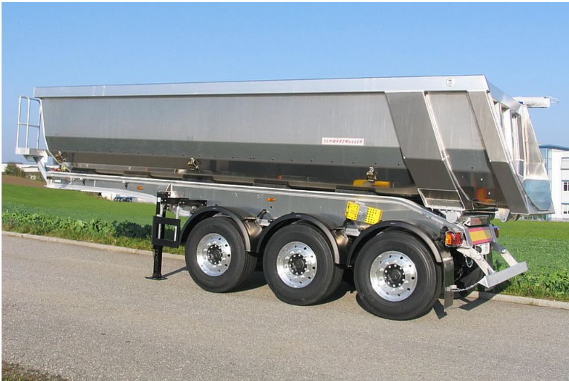
3-tengelyes, hátrabilenő, teljesen alumínium félpótkocsi, szegmentívű alumínium puttonnal
