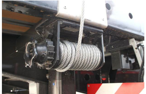
Lanové navijáky: zkontrolovat jejich řádnou funkčnost a upevnění.
