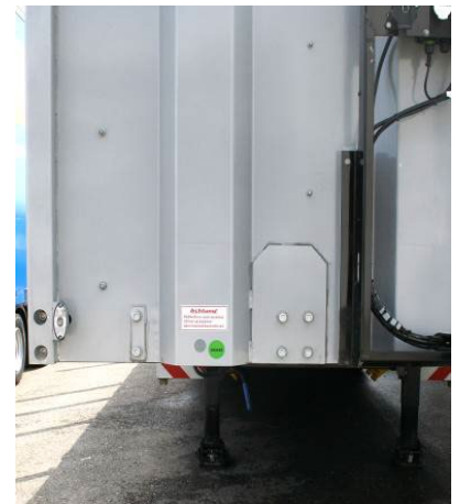
Spodní část předního čela: zkontrolovat upevnění všech šroubů.
