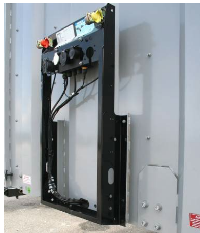
Držák přípojů: zkontrolovat upevnění nýtů a šroubů.
