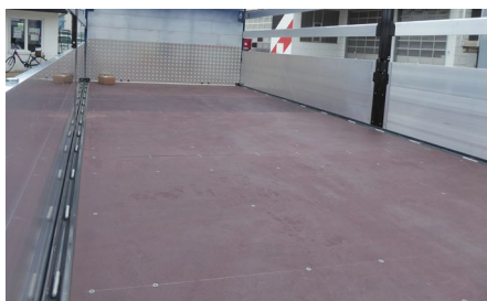
Nejrůznější provedení upínacích třmenů po stranách podlahy.
