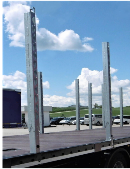
Všechny klanice a jejich uložení/ kapsy: zkontrolovat svary na praskliny.
