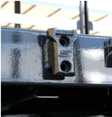
Rungenlager: Schweißnähte auf Risse prüfen
