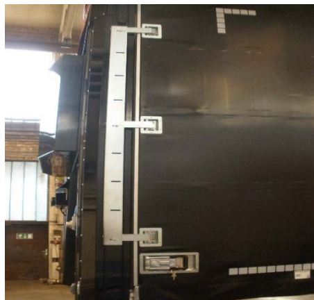
Quick Lock door, Verschluss auf Funktion und Verschleiß prüfen, auch auf Ecksäule hinten anbaubar
