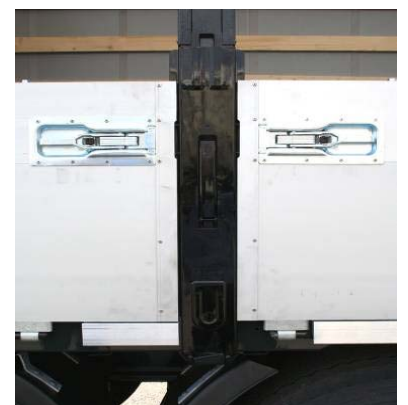
Bordwände: Nieten auf Festsitz prüfen
