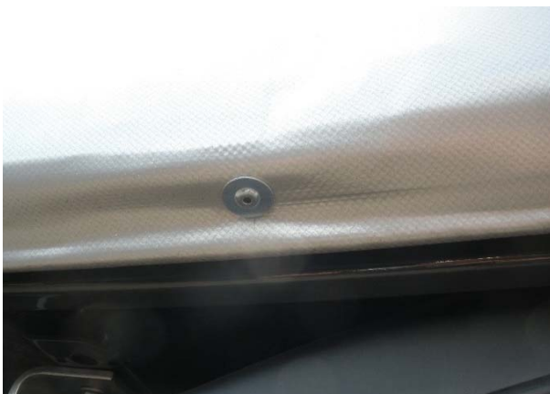
Vernietung der Seitenplane unten auf Festsitz prüfen
