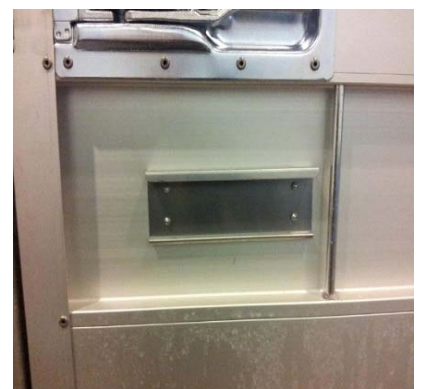
Quick-Slide Verschluss: Nieten auf Festsitz prüfen
