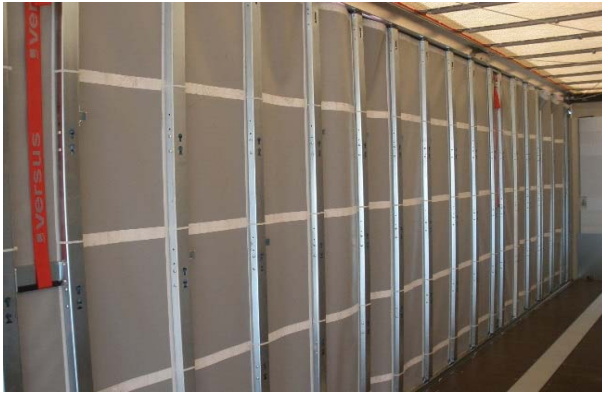
Quick Slider Sichtprüfung auf plastische Verformung etc.
