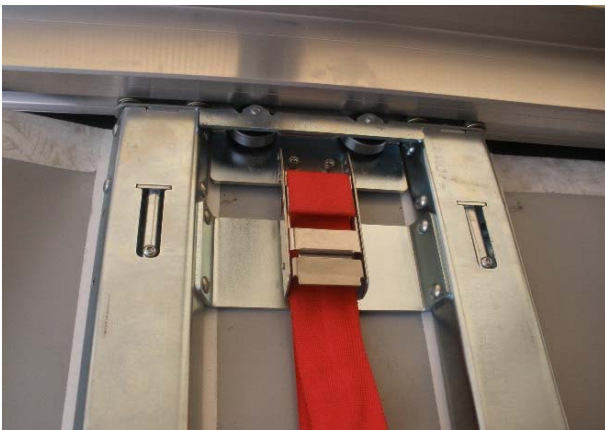
Laufwagen oben u. unten auf Funktion u. Verschleiß prüfen, Schraub- u. Nietverbind. auf Festsitz
