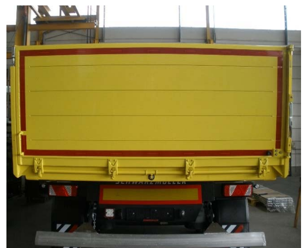
Rückwand zusätzlich schwenkbar: Sämtliche bewegliche Anbauteile wie Scharniere, Verschlüsse, Bolzen, Zapfen etc. auf Verschleiß und Funktion prüfen
