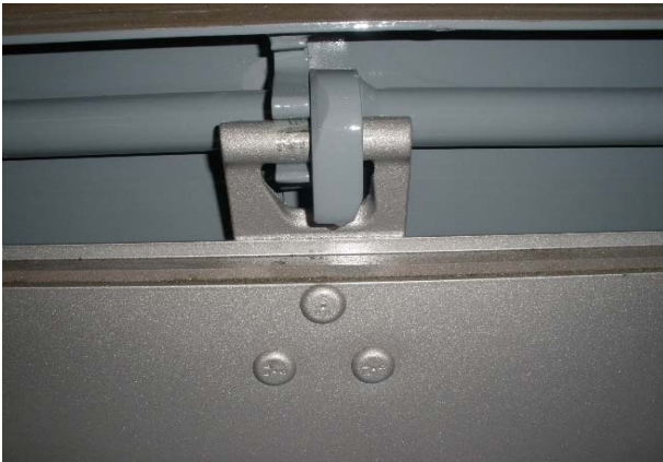
Zentralverriegelung: Sichtprüfung auf Abnützung, Spiel etc.
