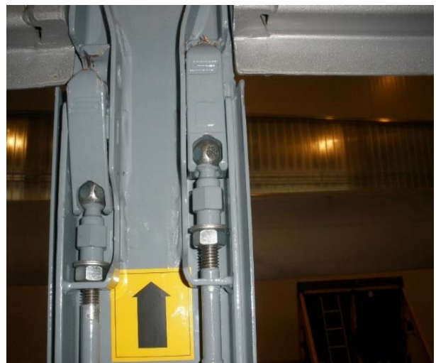
Vorderwand, Mittelsäule(n) und Ecksäule hinten auf Funktion der Verriegelungen prüfen
