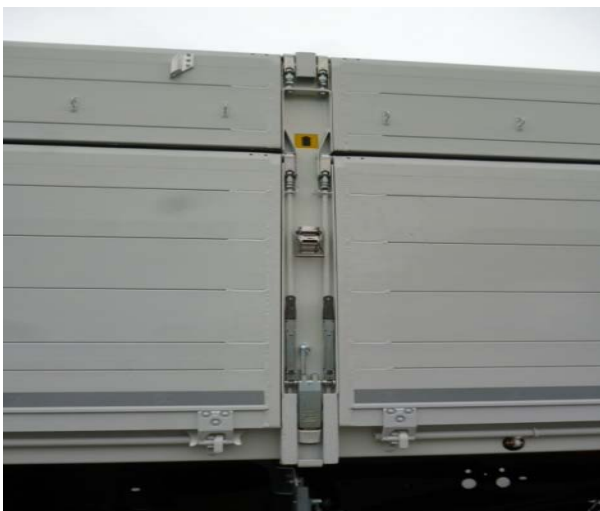
Vorderwand, Mittelsäule(n) und Ecksäule hinten auf Funktion der Verriegelungen prüfen
