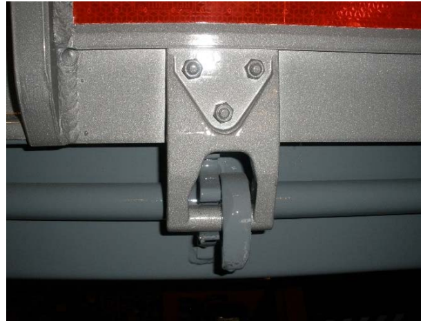
Scharniere: Schweißnähte auf Risse, Verschraubung auf Festsitz prüfen
