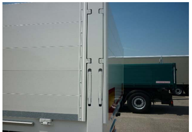
Bordwände: Vernietung auf Festsitz prüfen
