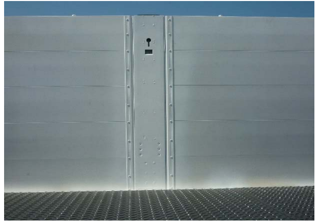
Bordwände: Vernietung auf Festsitz prüfen
