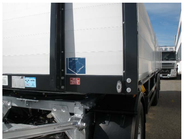
Gerätehalter: Alle Nieten und Schrauben auf Festsitz prüfen
