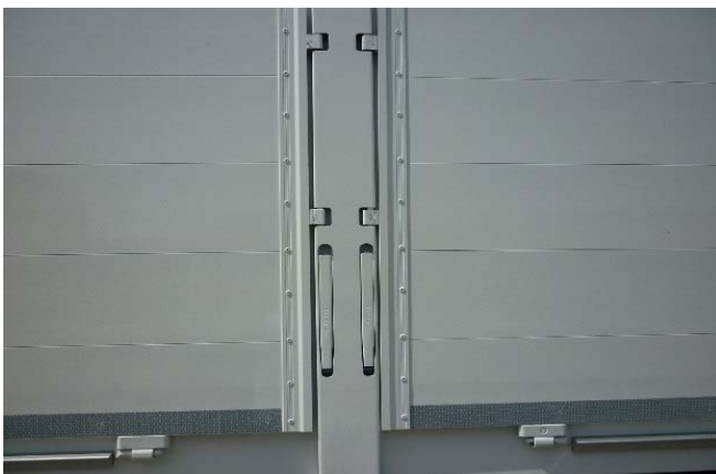
Mittel-, Ecksäule vorne und hinten auf Funktion der Verriegelungen prüfen
