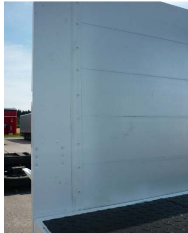
Bordwände: Vernietung auf Festsitz prüfen
