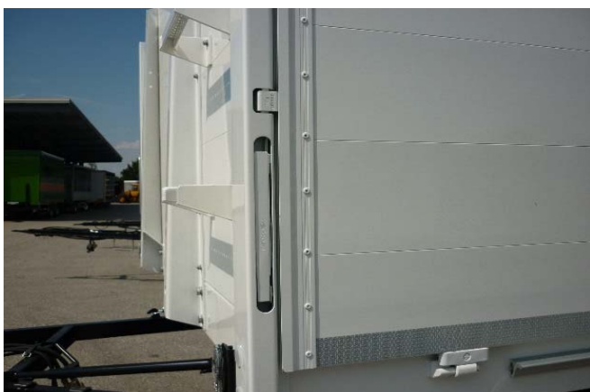
Verschraubung Ecksäule vorne auf Festsitz prüfen
