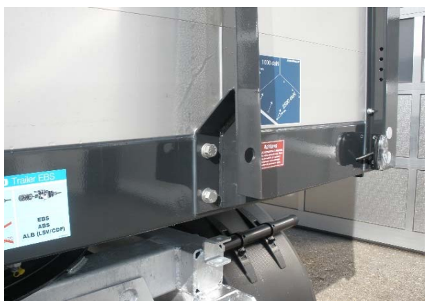
Verschraubung Vorderwandstütze auf Festsitz prüfen
