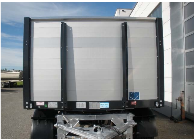
Alle Nieten und Schrauben auf Festsitz prüfen
