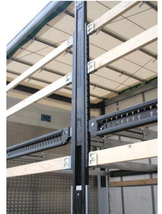
Mittelsäule: Befestigung der Lattentaschen prüfen
