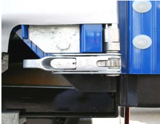
Spanngetriebe hinten: auf ordnungsgemäße Funktion prüfen, Adapter für Planenspannrohr auf Beschädigungen prüfen
