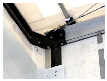
Ecksäule vorne: Schrauben und Nieten auf Festsitz prüfen
