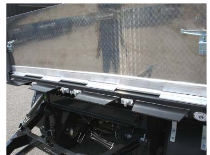
Schrauben der Scharniere auf Festsitz prüfen
