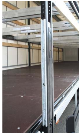
Mittelsäulen seitl. Unten: Nieten auf Festsitz prüf.
