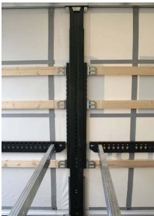
Mittelsäulen: Nieten u. Schrauben a. Festsitz prüf.
