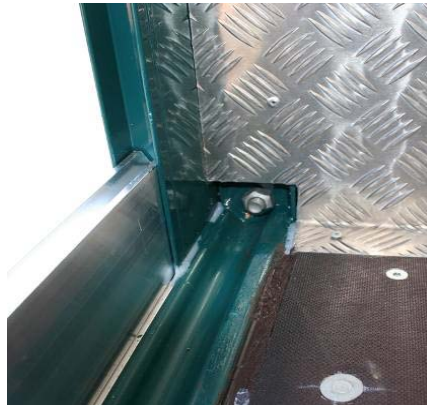
Verschraubung Ecksäule vorne auf Festsitz prüfen (innen)
