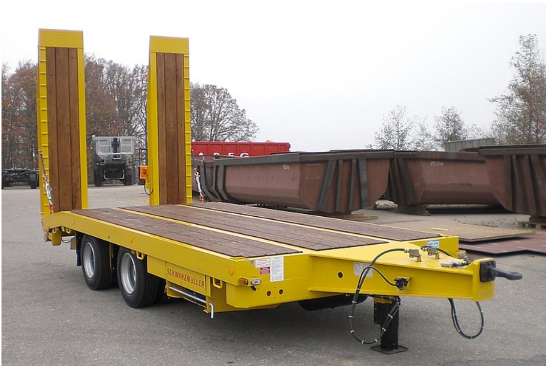
Zentralachs-Tiefpladeanhänger mit geradem Plateau
