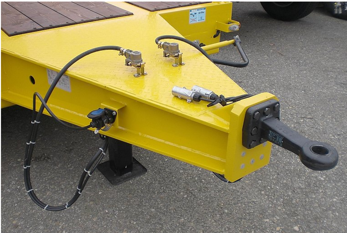
Zugvorrichtung vor dem Brückendeckel zusammengezogen, mit geschraubter Zugöse
