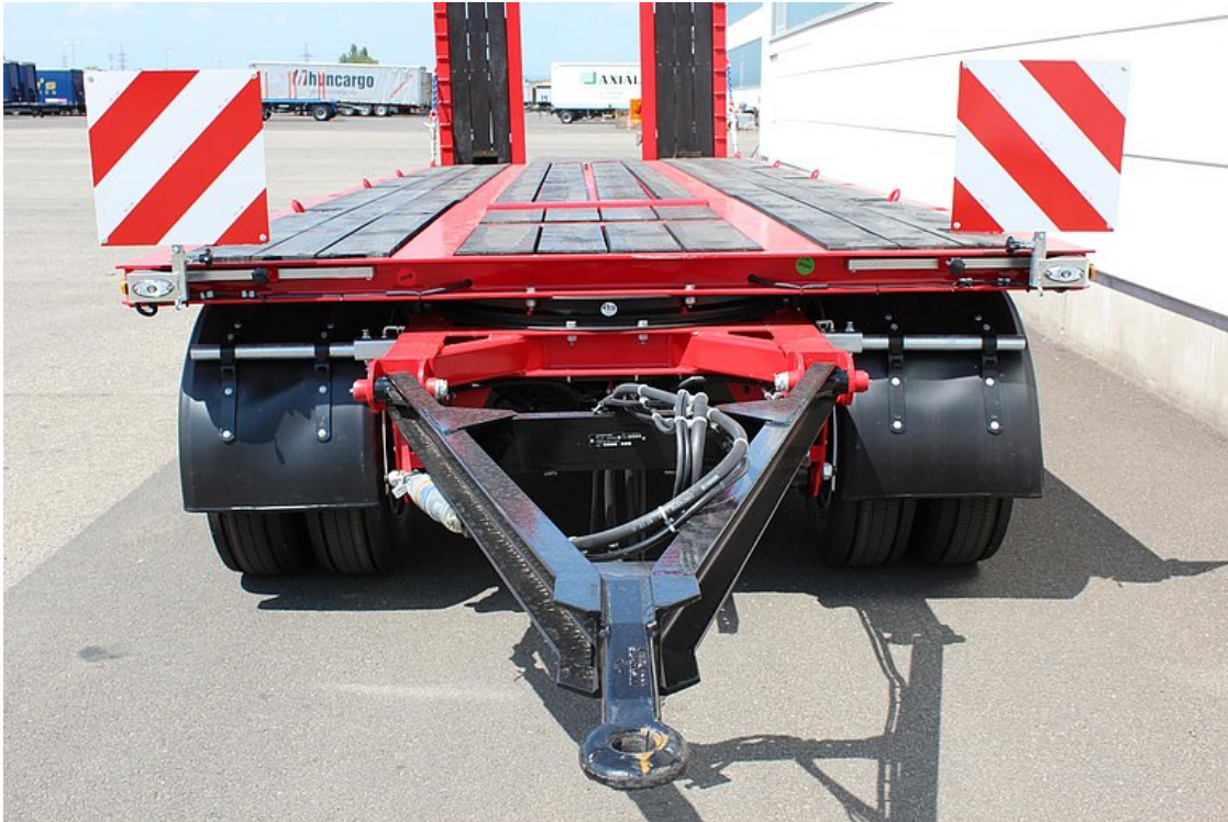
Vorne Drehgestell inkl. Zuggabel und ausziehbaren Warntafeln für Überbreitetransporte am Rahmen
