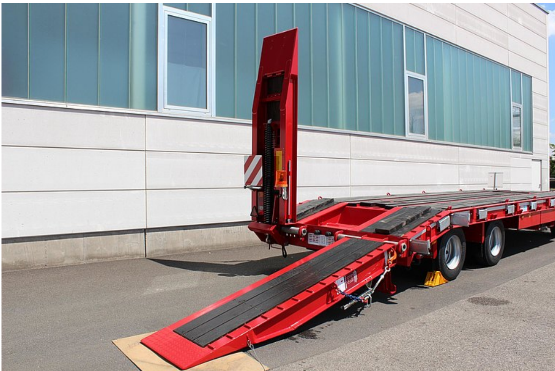
2 Klappbare 1-teilige Auffahrrampen mit Hartholzbelag
