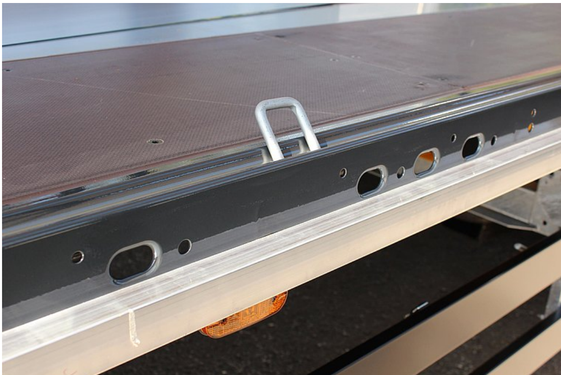
Loch-Außenrahmen mit Lochabstand ca. 100 mm, Langloch 40/25 mm nach DIN EN 12640 und 23 Paar versenkte 2,5 t Zurrbügel
