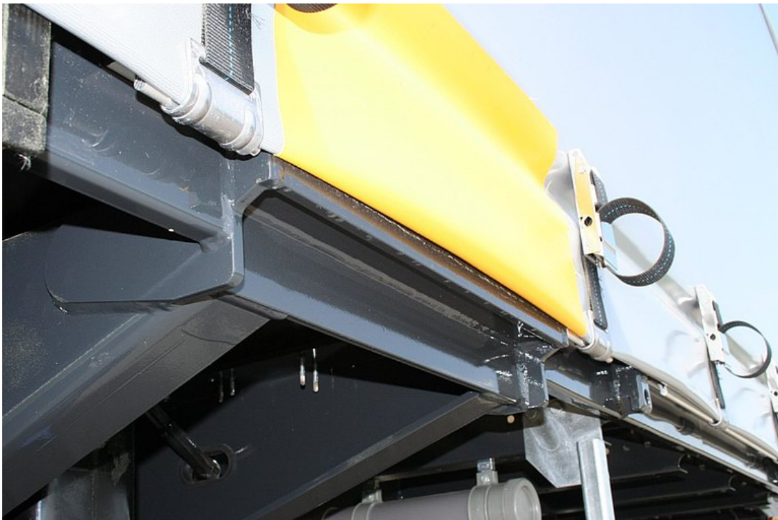
Rahmenkonstruktion verstärkt mit 4 Greifkanten für kranbare Bahnverladung
