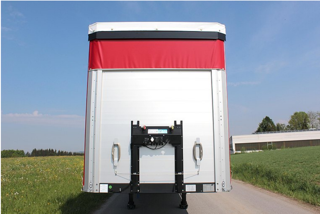
Verstärkte Aluminium-Hohlprofil-Vorderwand mit integriertem Gerätehalter
