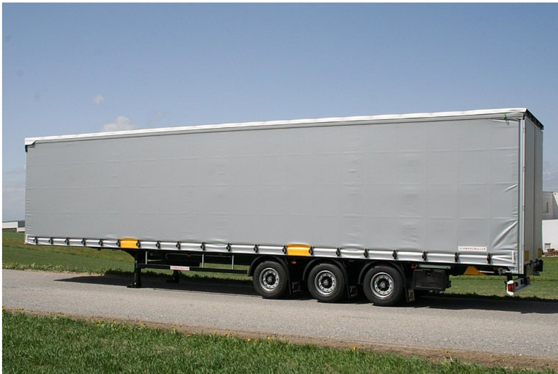
Korrosionsarme hochwertige Aluminium-Aufbaukomponenten, geprüft nach EN 12642 XL
