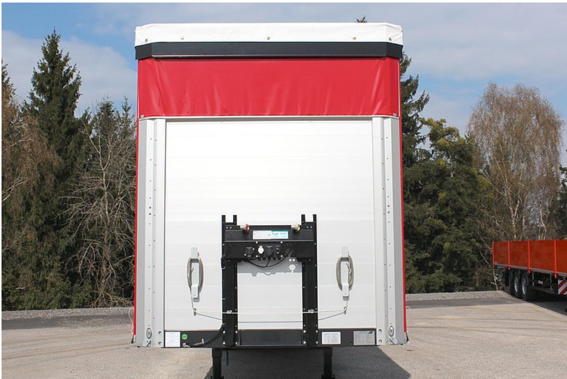
Verstärkte Aluminium-Hohlprofil-Vorderwand mit integriertem Gerätehalter
