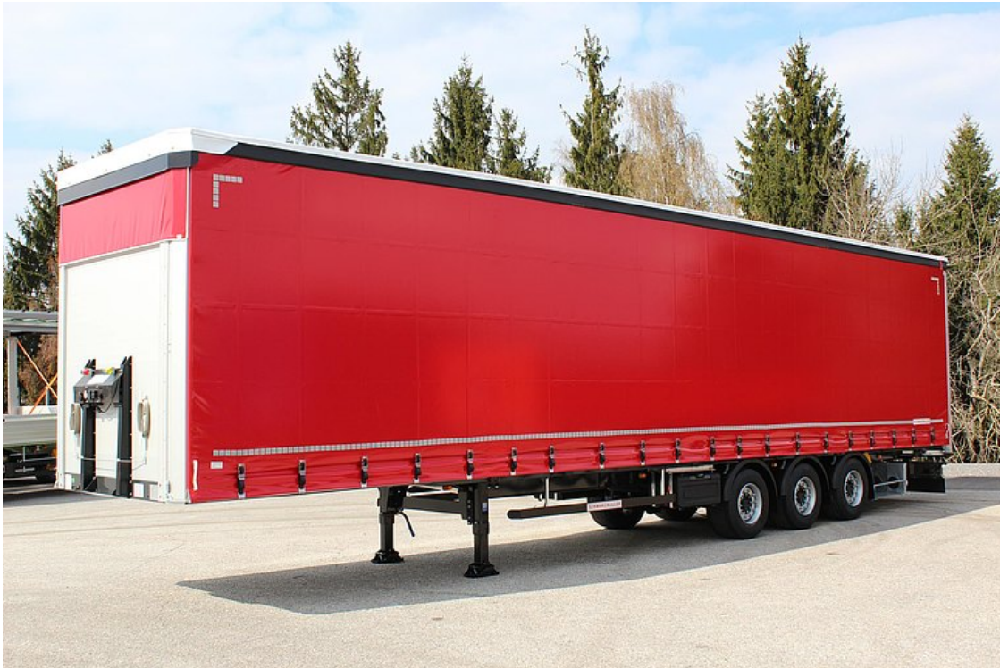
Korrosionsarme hochwertige Aluminium-Aufbaukomponenten, geprüft nach EN 12642
