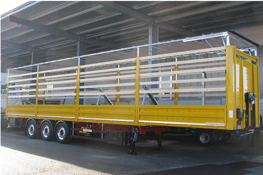
3-Achs-Leichtbau-Plateausattelanhänger - Coil - Schrägverlader
