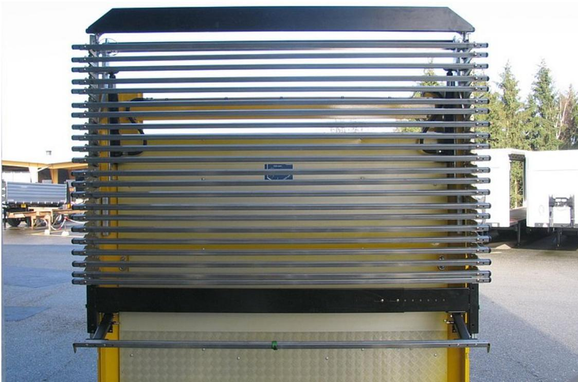
Schieberverdeck an die Vorderwand innen hydraulisch abklappbar - für offene Blechtransporte
