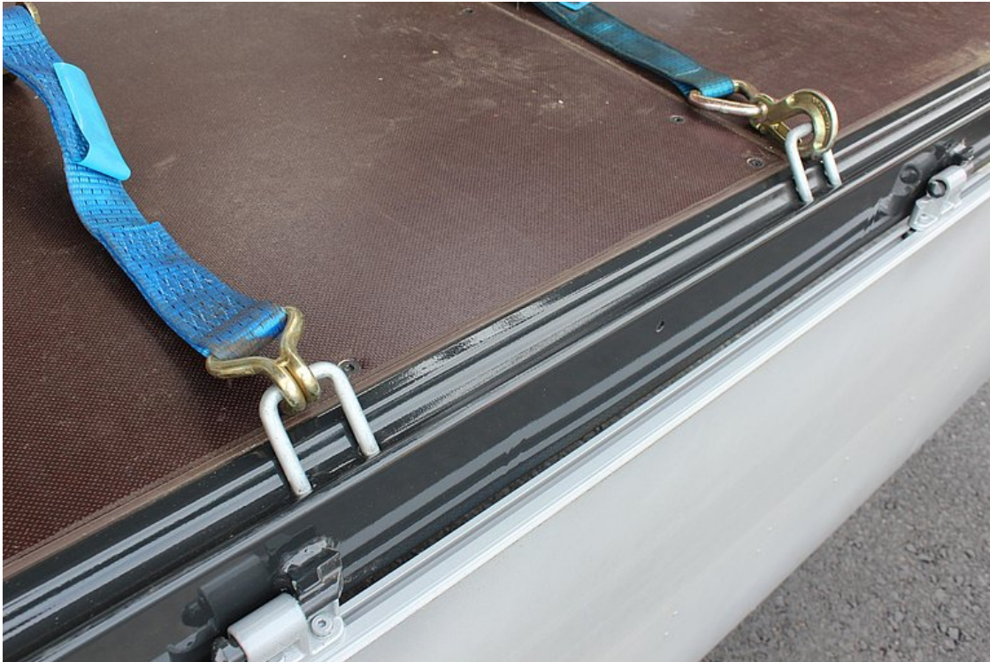
Zurrbügel-Außenrahmen mit 15 Paar versenkten 2,5 t Zurrbügel für Ladungssicherung
