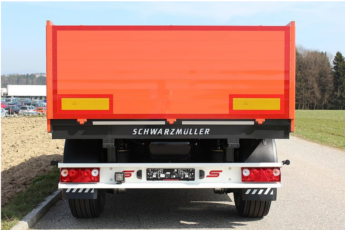
Abklappbare Aluminium-Hohlprofil-Rückwand, Einfassung auch innen vernietet, abklappbar mit Kinnegrip-Doppelverriegelung
