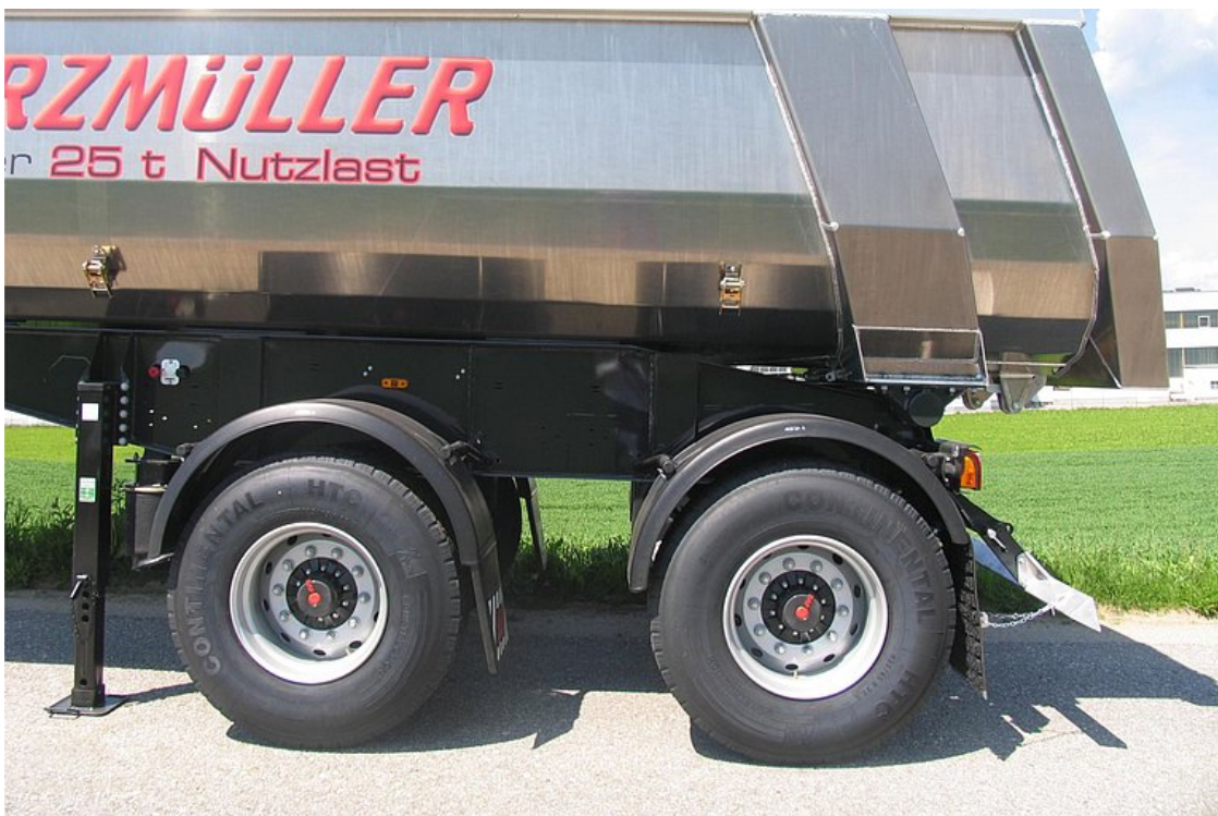
Achsen mit Radstand 1.810 mm
