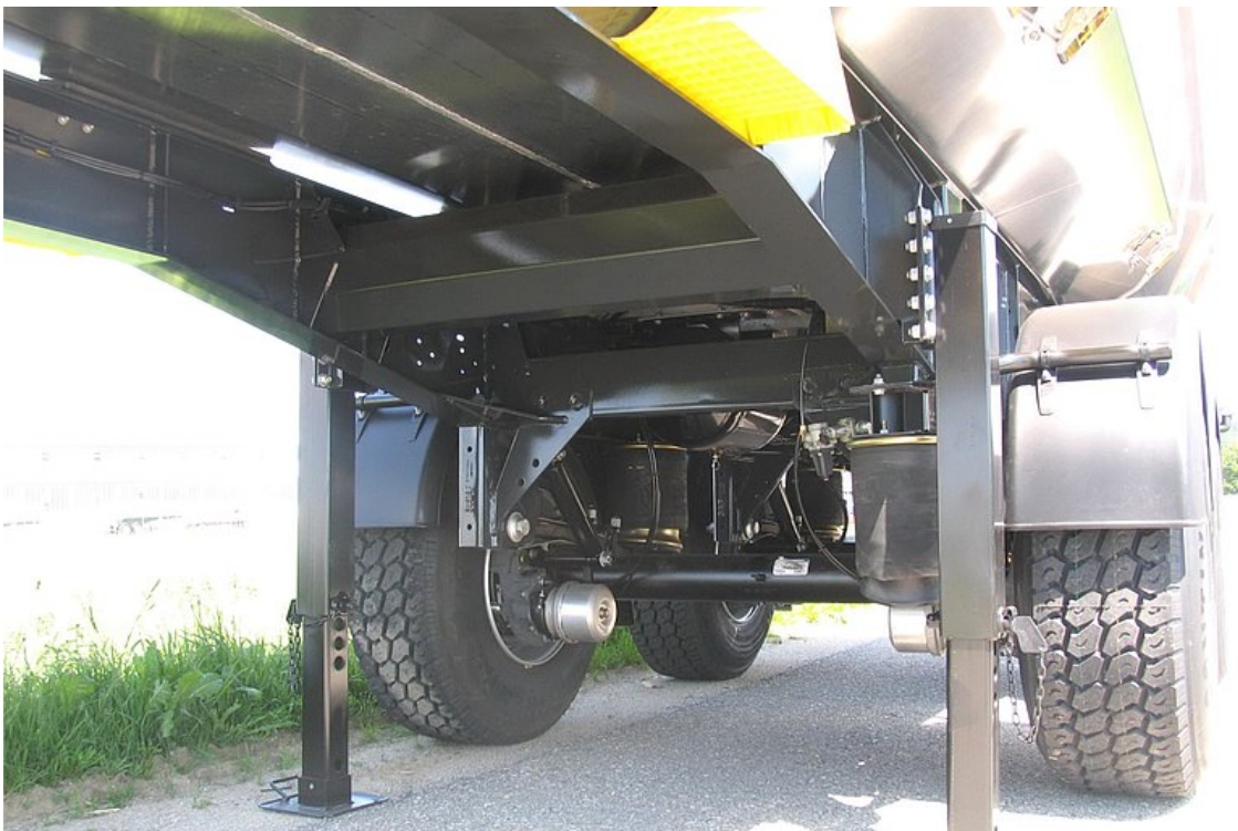
Stabile und verwindungssteife Fahrgestellkonstruktion mit zusätzlichen Torsionsrohren
