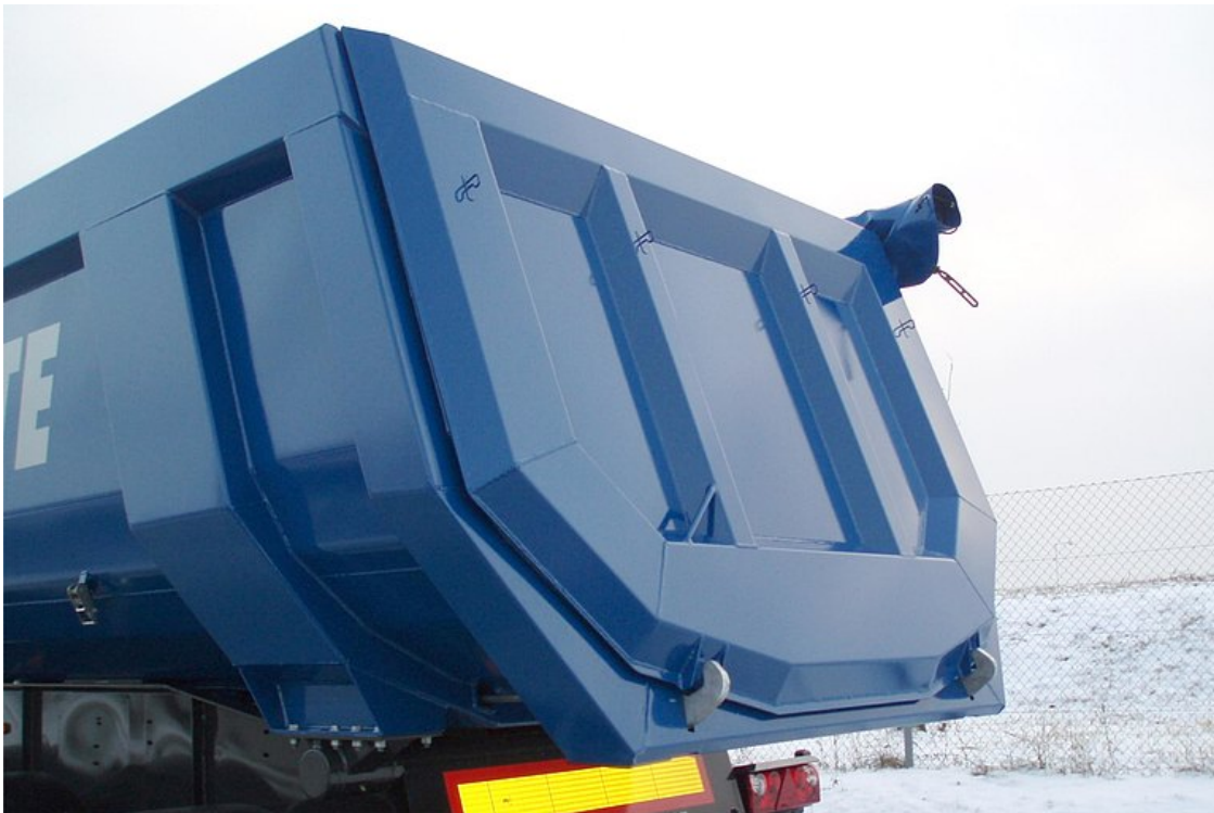
OPTIONAL: Außenliegende Rückwand - dadurch ist ein höheres Ladevolumen gewährleistet
