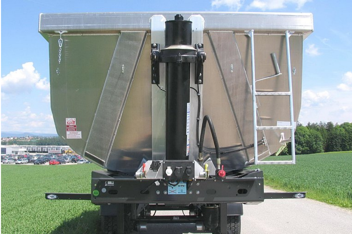
Schräge Vorderwand mit hartverchromtem, qualitativ hochwertigem Frontkippszylinder
