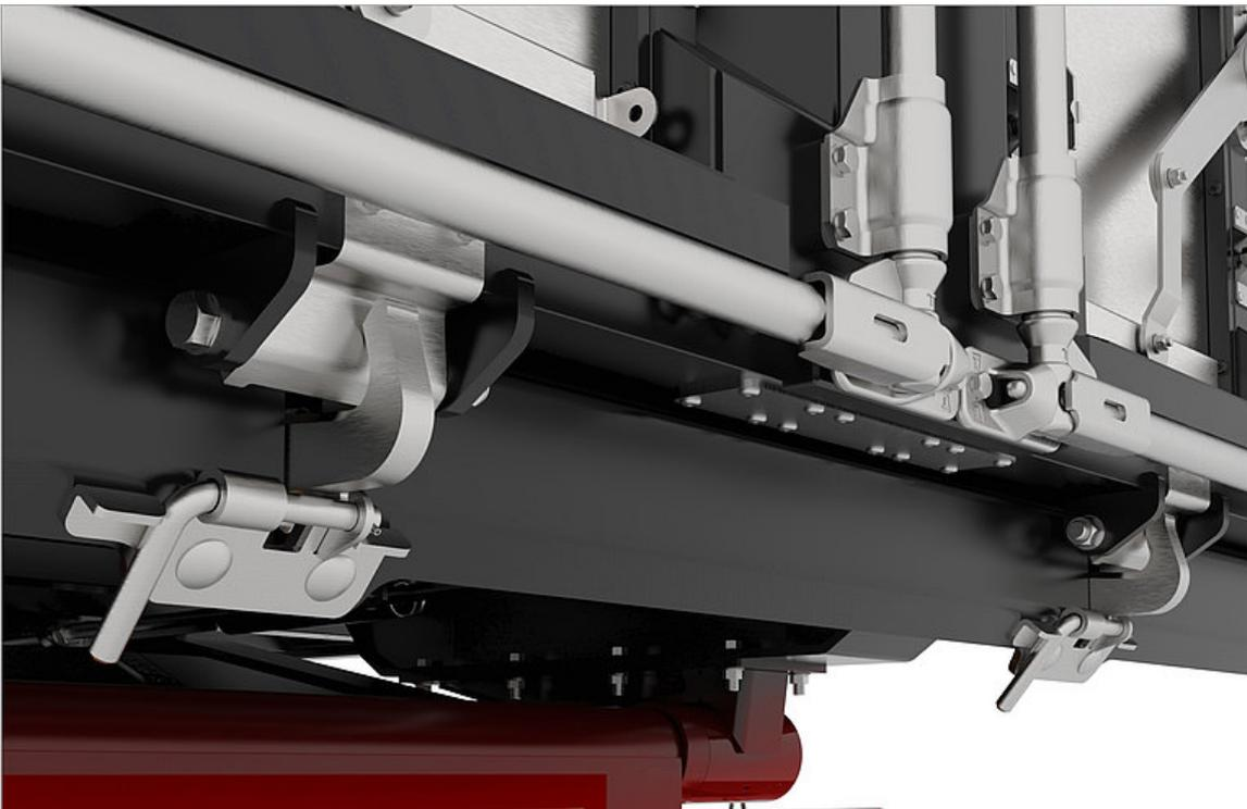
Automatischer Pendelverschluss: Über ein spezielles Gestänge wird die Heckklappe beim Kippvorgang automatisch entriegelt. Auch die Verriegelung beim Absenken erfolgt dadurch automatisch.
