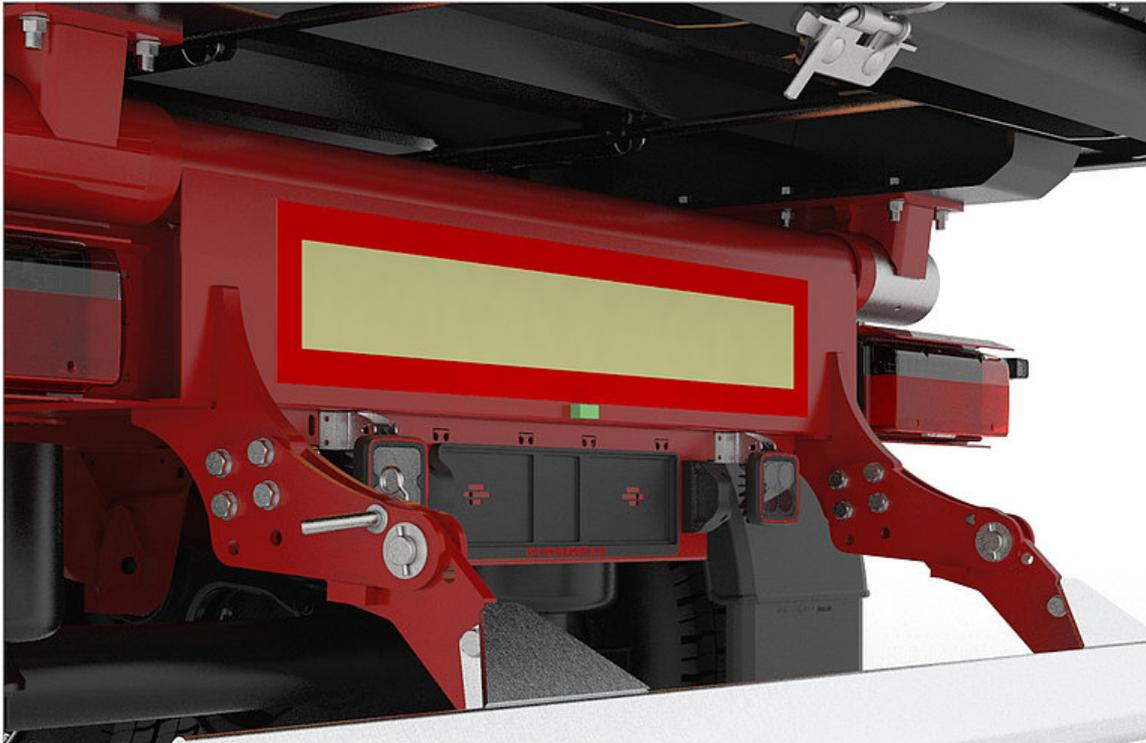
Libelle hinten: Die Libelle am Abschlußblech ist ein einfaches Hilfsmittel zur Kontrolle der Waagrechtstellung und reduziert somit das Unfallrisiko.
