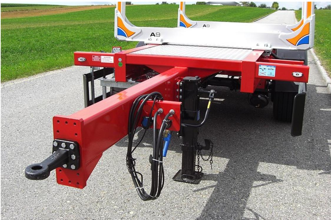
Höhenverstellbare Zugstange für Zentralachs-Schwerlastkupplung
