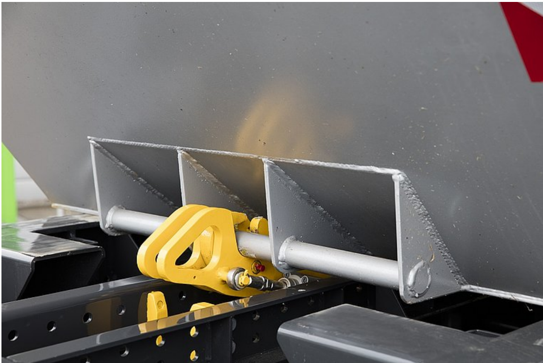
OPTIONAL: Kettenlose Ladungssicherung Multi-Fix
