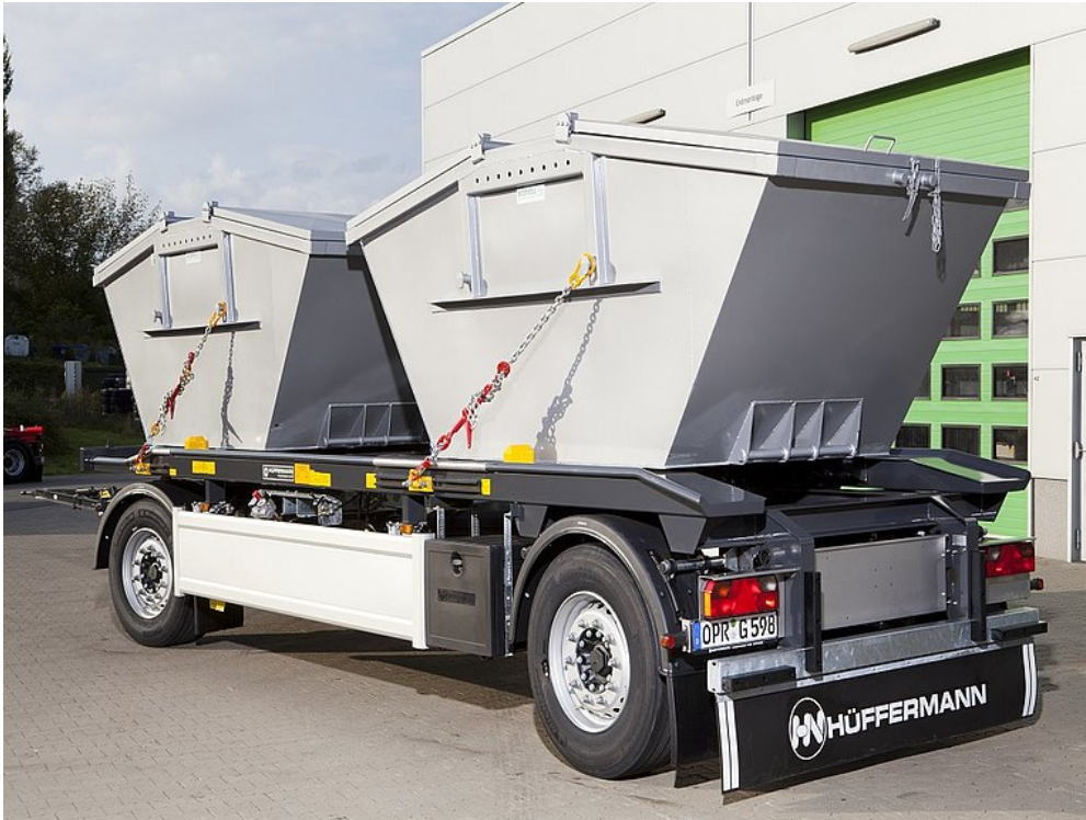
Kombinierte Ladungssicherung mit Zentrier-Fix und Zurrketten
