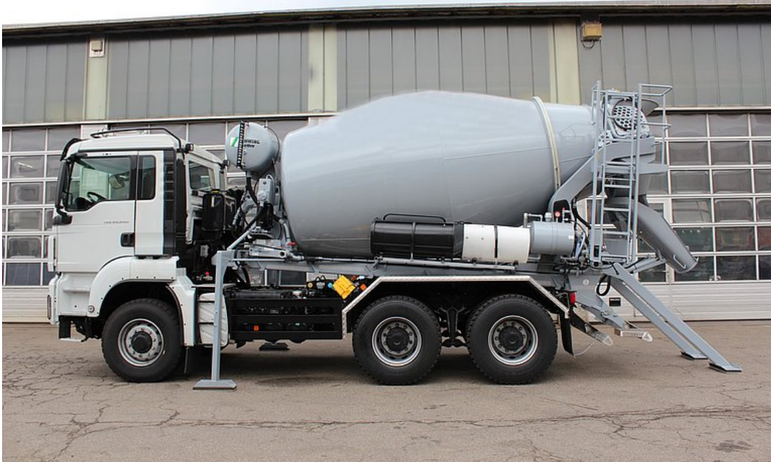
Schnellwechsellanlage - 3-Seiten-Kippaufbau / Betonmischer
