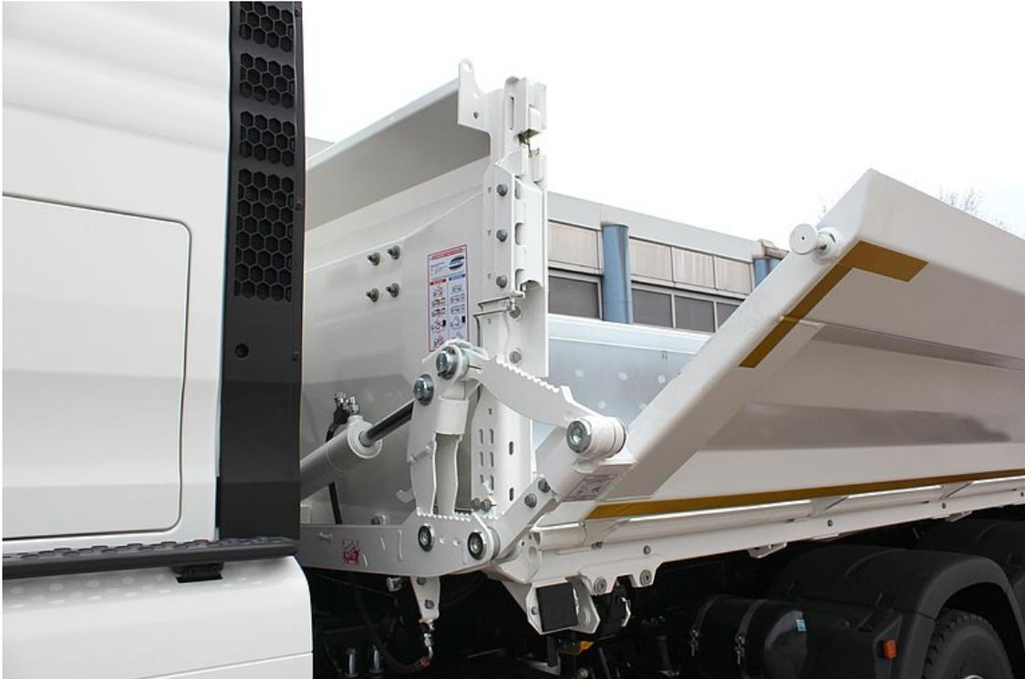
OPTIONAL: Linkseitig Bordmatic = hydraulisch abklappbare Seitenbordwand
