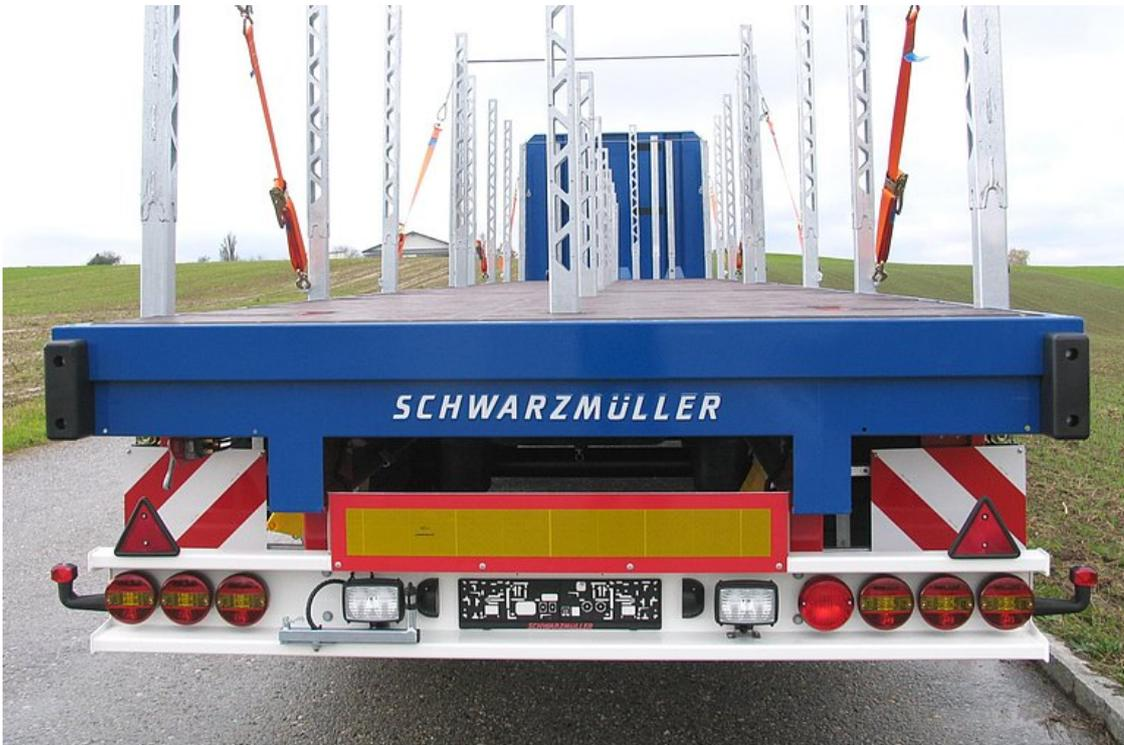
Unterfahrtschutz mit integriertem Hecklichtensystem und Gummipuffer
