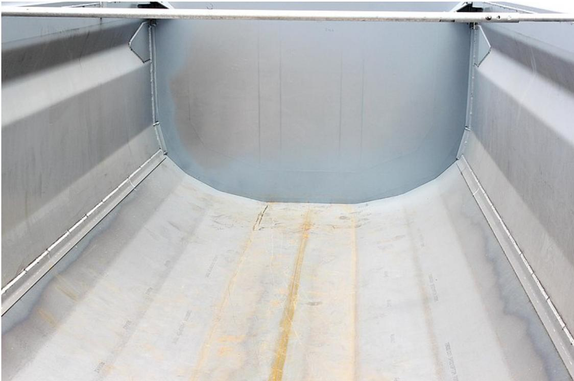
Durchgehender Stahl Verschleißboden 3 mm, mit aufgeschweißter Alu-Einfassung
