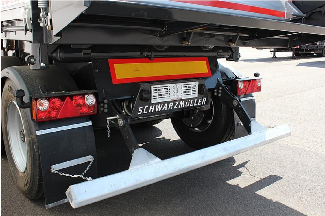
Klappbarer Unterfahrschutz für Fertigereinsatz
