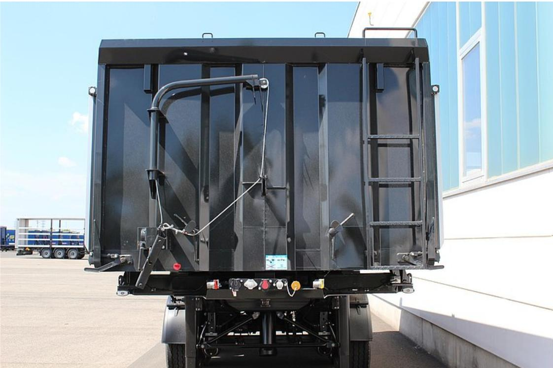
Fixe Stahlblech-Vorderwand mit Bindeösen, Aufstiegleiter und Haltebügeln
