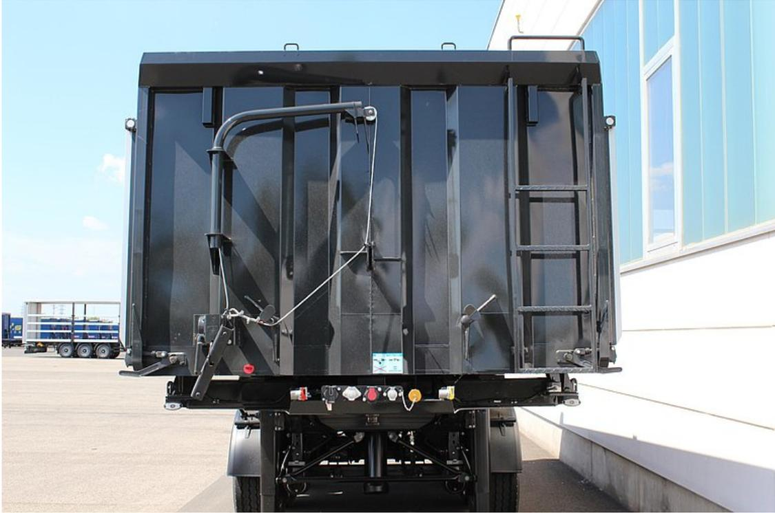
Fixe Stahlblech-Vorderwand mit Bindeösen, Aufstiegleiter und Haltebügel
