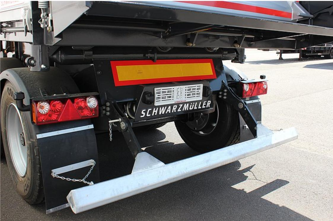
Klappbarer Unterfahrschutz für Fertigerinsatz
