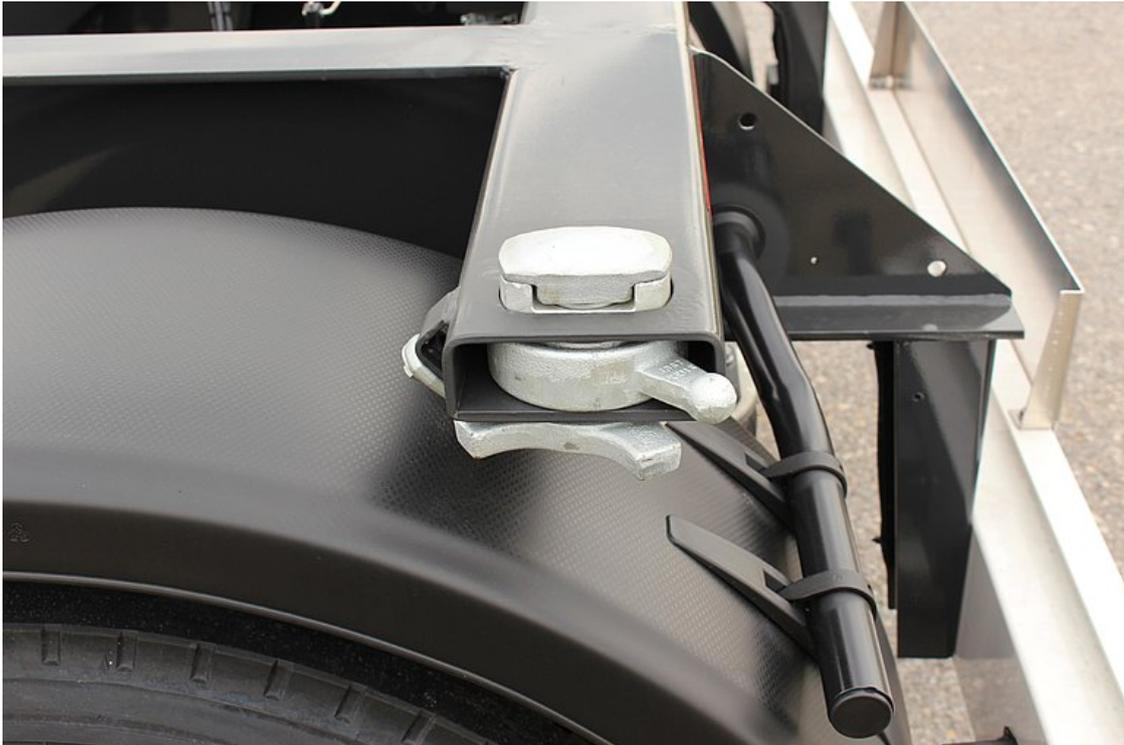
Auflagrträger samt 4 Containerverschlüsse nach EN 284 (20ft-Verriegelungsmaß)
