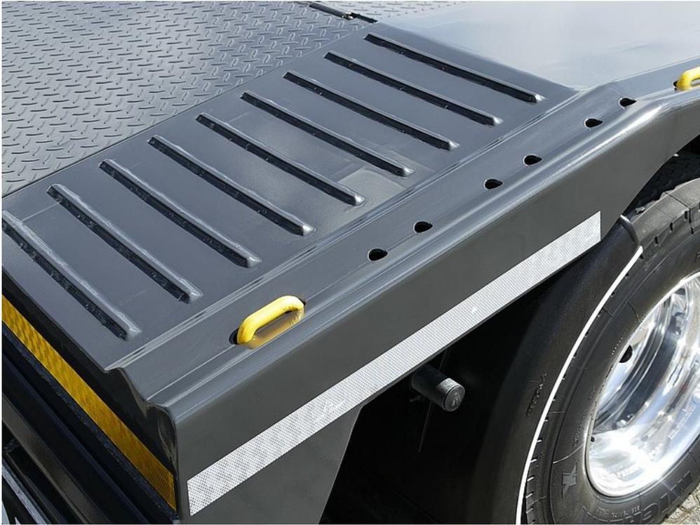
Versenkte und variabel umschraubbare Zurrpunkte im Außenrahmen
