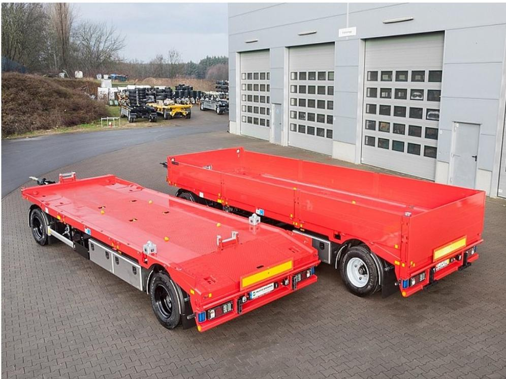
OPTIONAL: Links: ISO-Container Aufnahme, Seilwindenfenster. Rechts: Aluminiumbordwände
